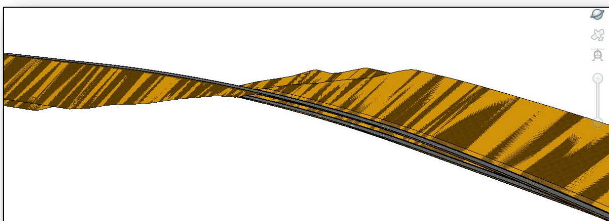
Figur 40: Viser et lite veg-segment fra et høybrekk der en ser at vegene er identisk på alle måter unntatt kurveradien.
