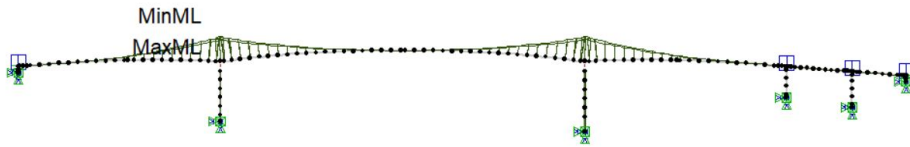
Figur 6.2: Momentdiagram med tvangskrefter like før kobling
