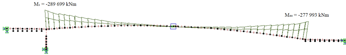
Figur 11.7: Dimensionerende moment SLSb
