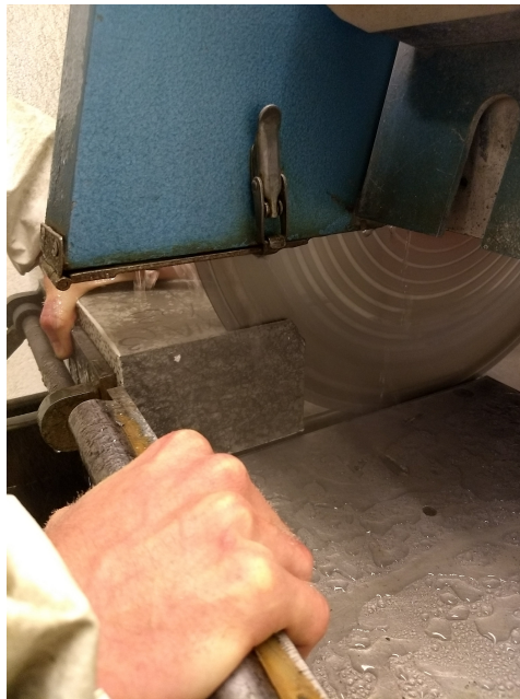
Figur 3.9: Kutting av overflaten på prisme
