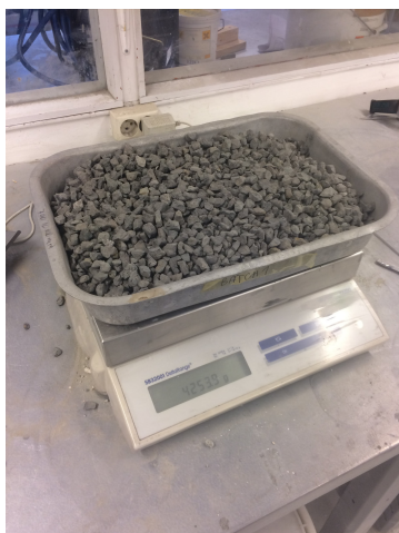
Figur 3.1: Veiing av tørket Stalite
