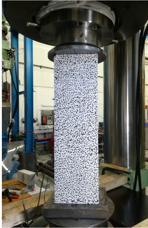
Figur 3.12: Prisme under sentrisk belastning.
