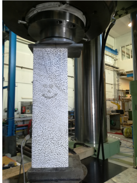
Figur 3.13: Prisme under eksentrisk belastning. e = 23,33 \text{ mm}
