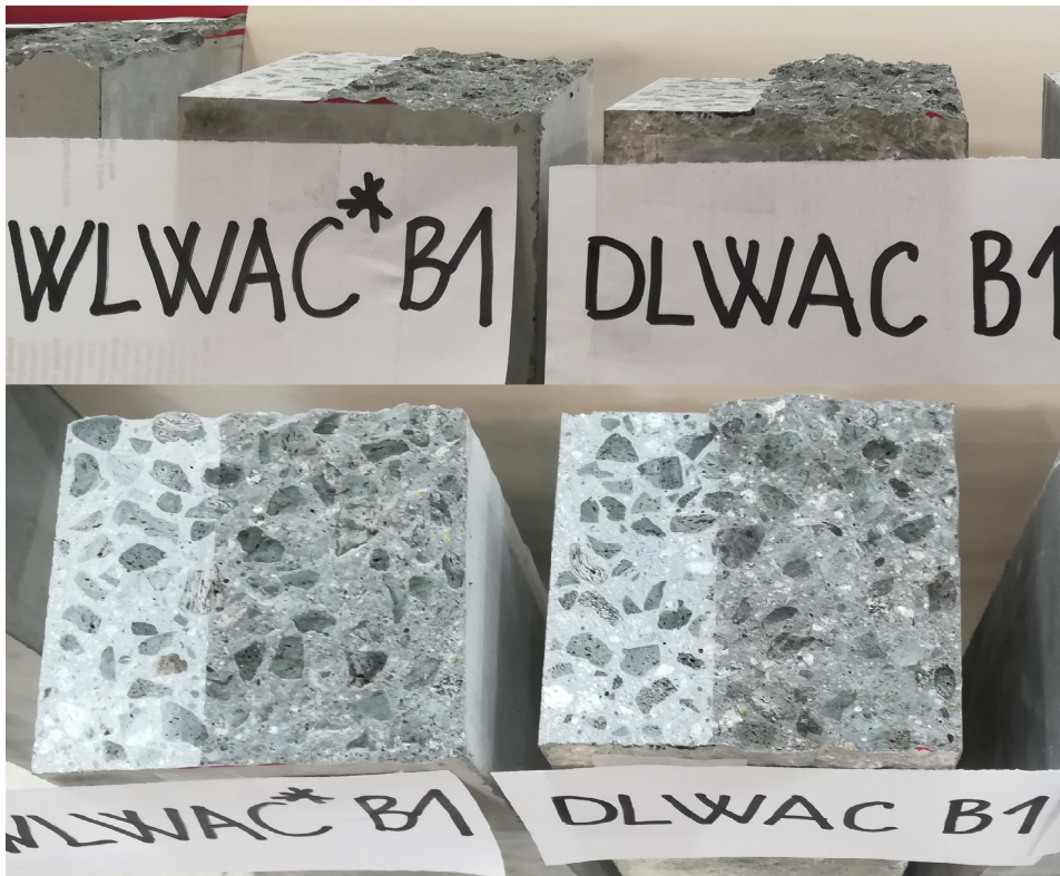
Figur 4.6: Bruddflate på bruddenergibjeltene
