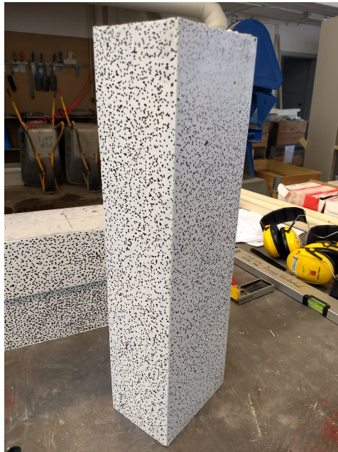
Figur 3.19: Prikkete prisme klargjort for DIC-analyse
