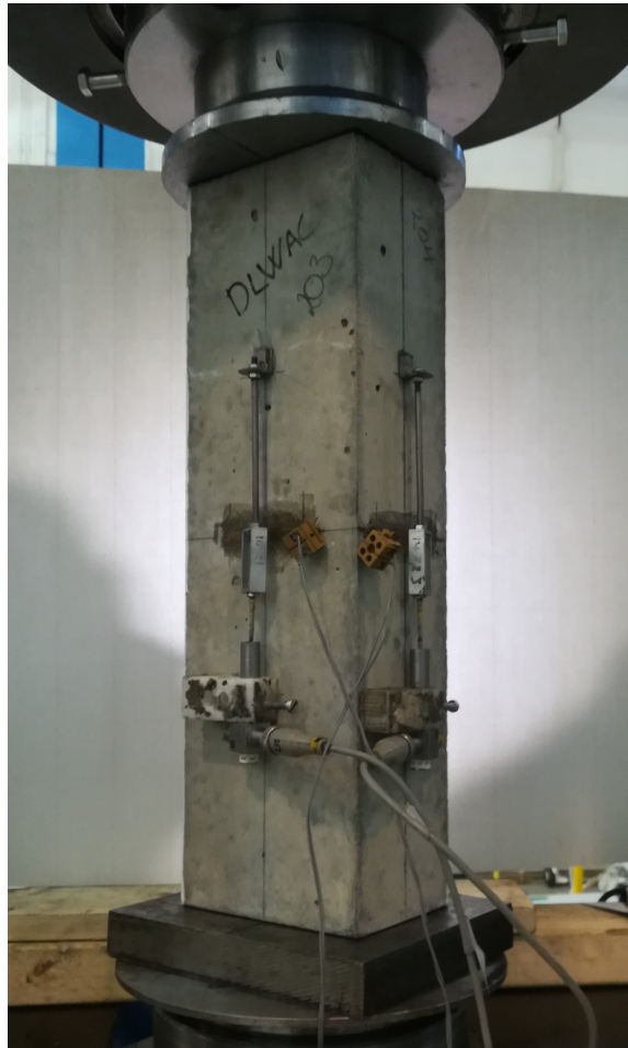
Figur 3.16: LVDT-er limt på prisme
