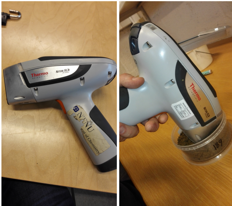
Figur 3.1.1: Til venstre: NTNUs Niton XL3t 900He, pXRF-analysator. Instrumentet ble benyttet ved analyse av jord både i felten og i laboratoriet i arbeid med prøvene fra Løkken Verk. Bildet til høyre demonstrerer bruk ved analyse av prøve i boks.
