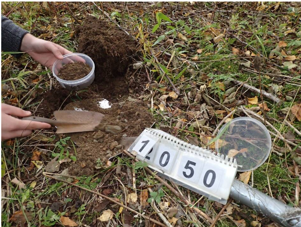
Figur 3.2.3: Demonstrasjon av prøvetaking. Prøve MEH105 blir samlet i merket prøveboks.
