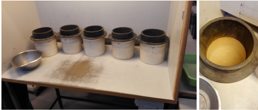
Figur 3.3.1: Det manuelle sikteutstyret benyttet ved NGU. 137 tørkede jordprøver ble siktet med 2mm masker.
