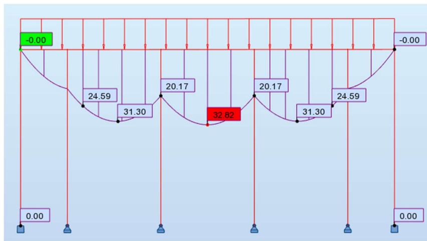
Figur C2.1: Momentdiagram for modell 1c. Hulldekkelast og egenvekt inkludert. E = 36\,000\text{ MPa}
