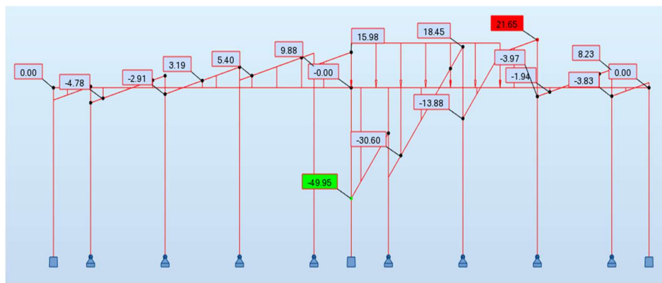
Figur 8.13: Største skjærkraft som kan oppstå ved montering av hulldekker på det første feltet
