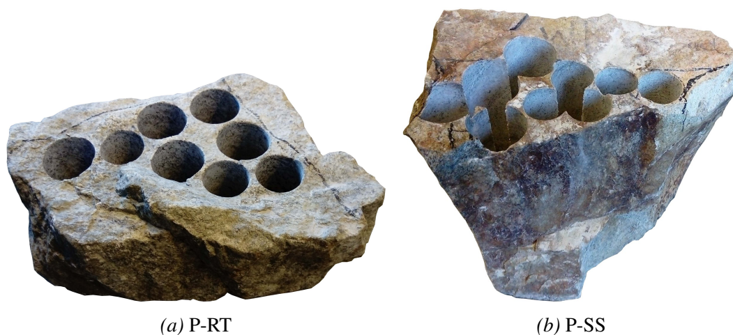
Figur 6.1: Bergartsprøver etter uttak av sylinderkjerner (foto: Snorre Solli).
