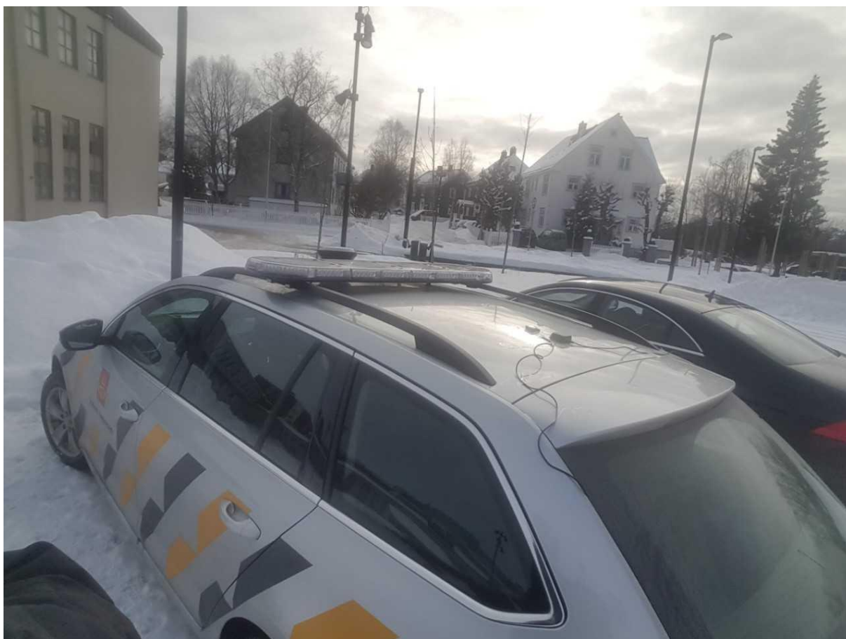
Figur 6: Bil med GNSS-mottakere festet på taket
