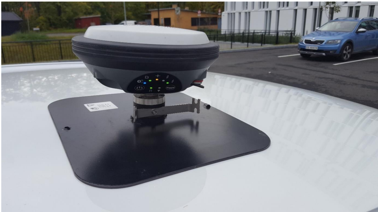
Figur 10: Leica-antennen montert på bil
