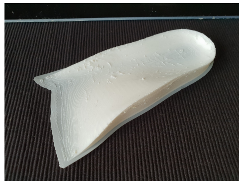
(d) PrimaSELECT Flex, Shore hardness: 45D.
