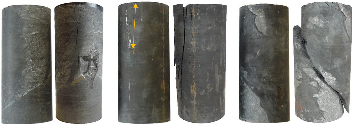
Figur 6.13 Prøve D før (til venstre) og etter (til høyre) brudd.
