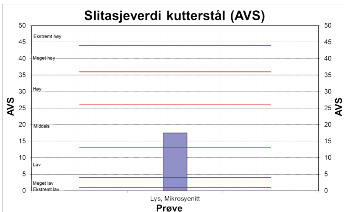
Figur B.33 Slitasjeverdi kutterstål for syenitt.
