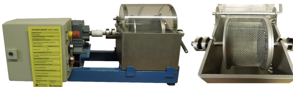
Figur 6.4 Apparaturen for «slake durability test». Bilde av trommelen til høyre.
