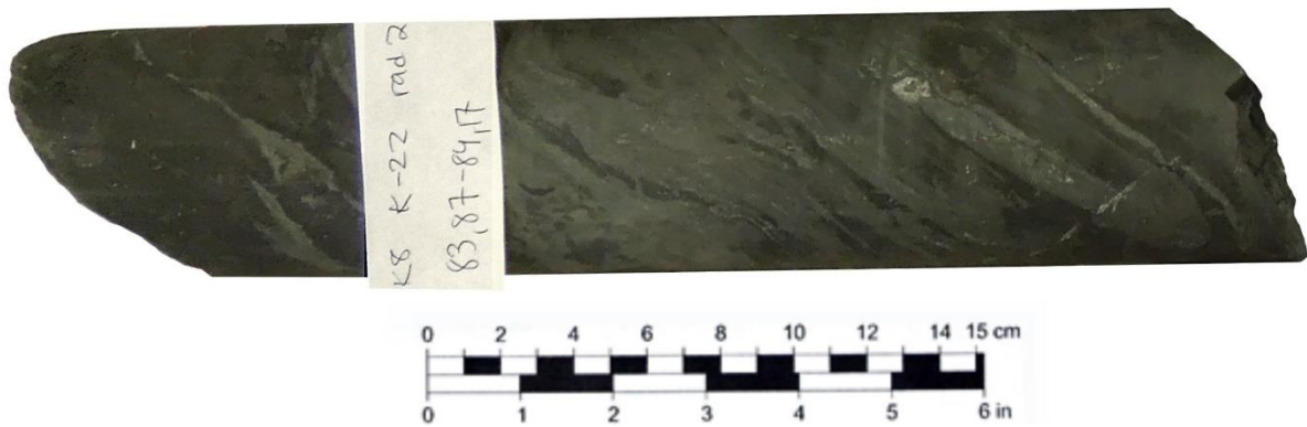
Figur B.6 Prøve A. Prøven ble ødelagt under preparering.
