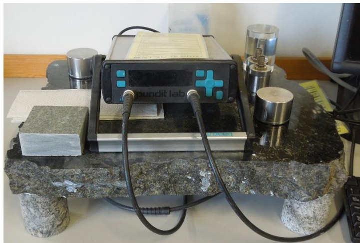
Figur 6.3 Pundit lab for test av lydhastighet.
