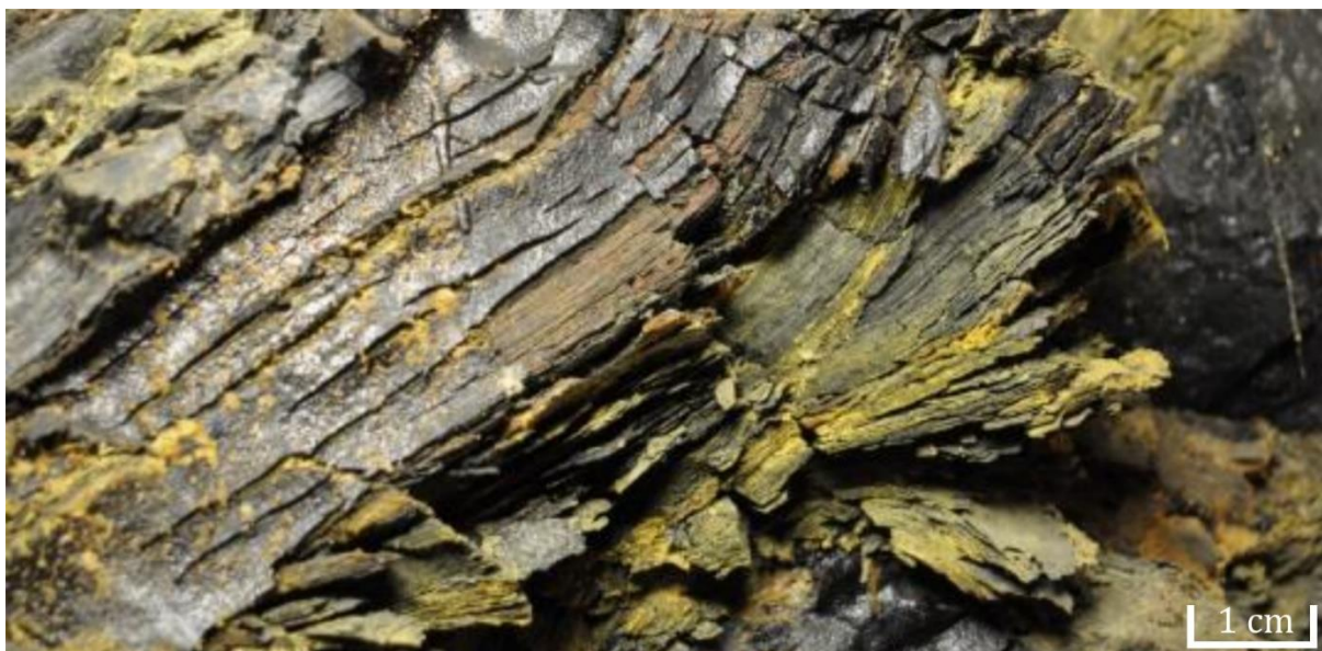
Figur 3.11 Svelling av alunskifer. Gule utfellinger er Fe 2 (SO 4 ) 2 (kopiatitt eller jarositt). Modifisert etter NGI (2015b).
