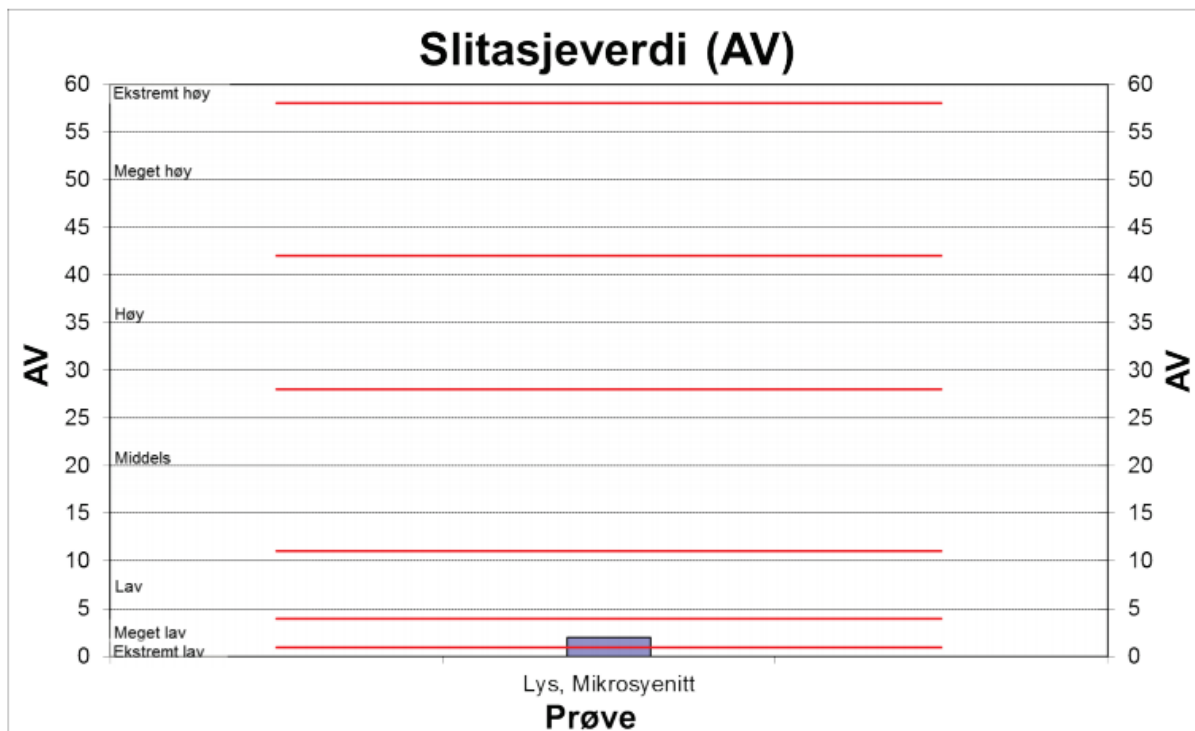
Figur B.34 Slitasjeverdi for syenitt.
