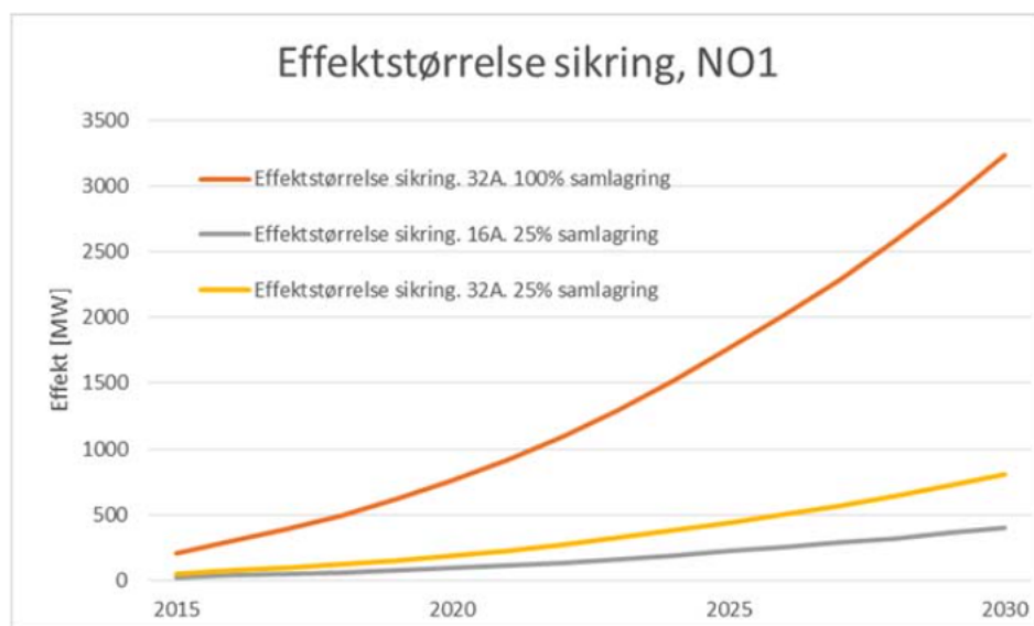
Figur 3.6: Kapasitet i et elbil-batterier begrenset av sikringer i bygg og tilgjengeligheten på bilbatteriene, hentet fra NVE-rapport [15]
