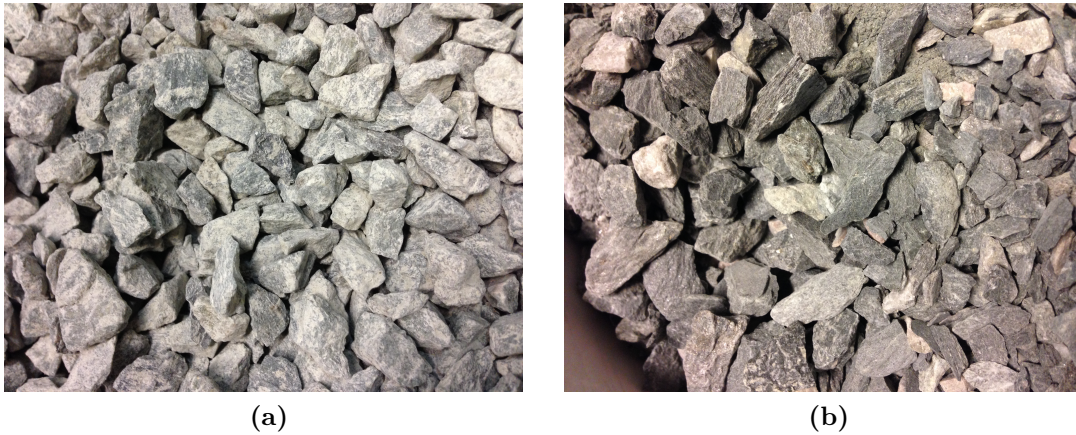
FIGUR 3.1: (a) Materiale 1: sterkt tilslag. (b) Materiale 2: svakt tilslag.
