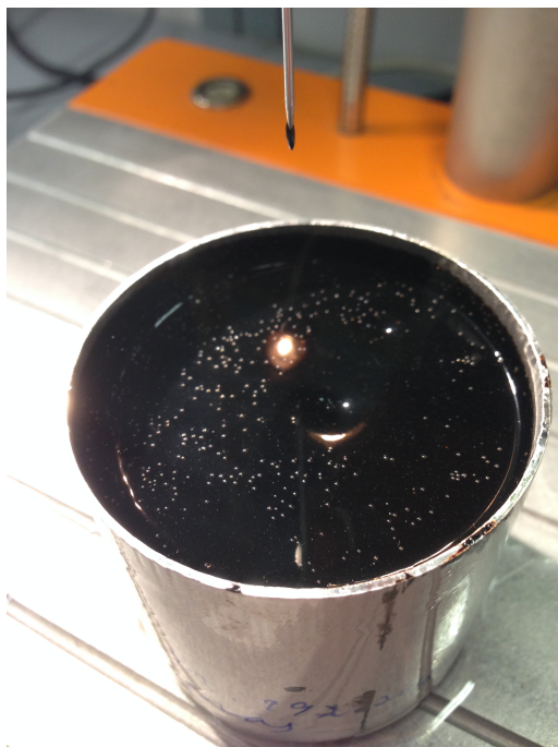
FIGUR 2.6: Bindemidlets stivhet kan bestemmes gjennom en penetrasjonstest.
