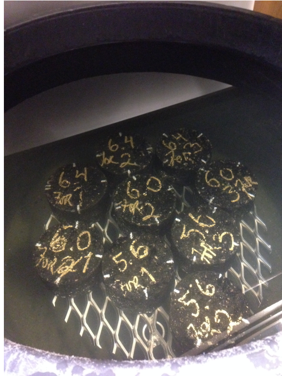
FIGUR 2.8: Marshallklosser til bestemmelse av densitet ved metode B.
