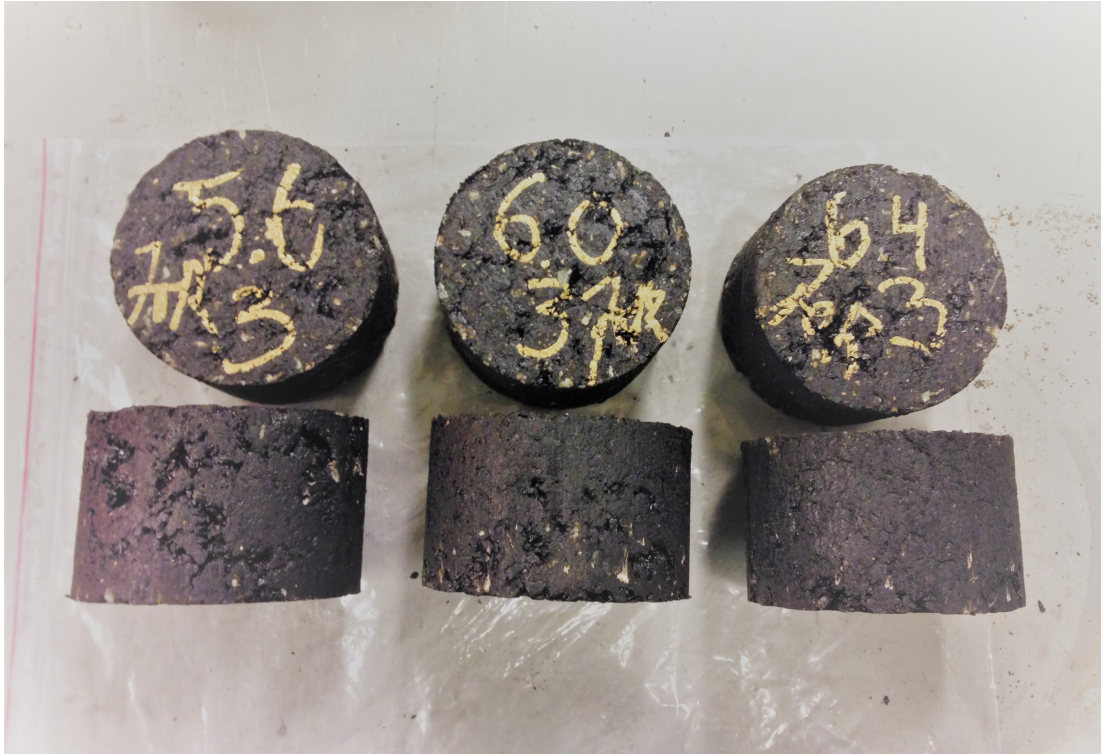
FIGUR 2.9: Ferdig preparerte prøver til proporsjoneringsformål, kompaktet med Marshall slagkompaktering.
