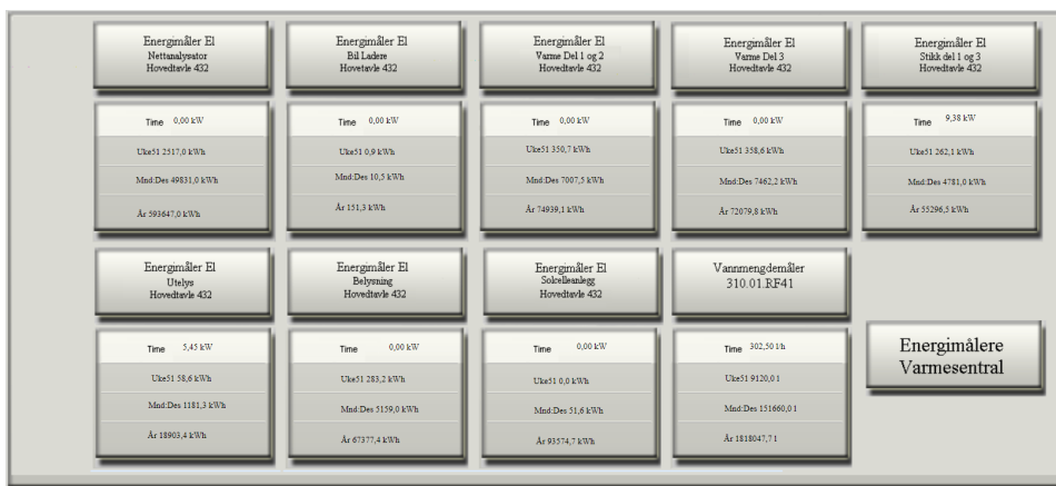
Figur 7.3: Energimålere på Eidet omsorgssenter
