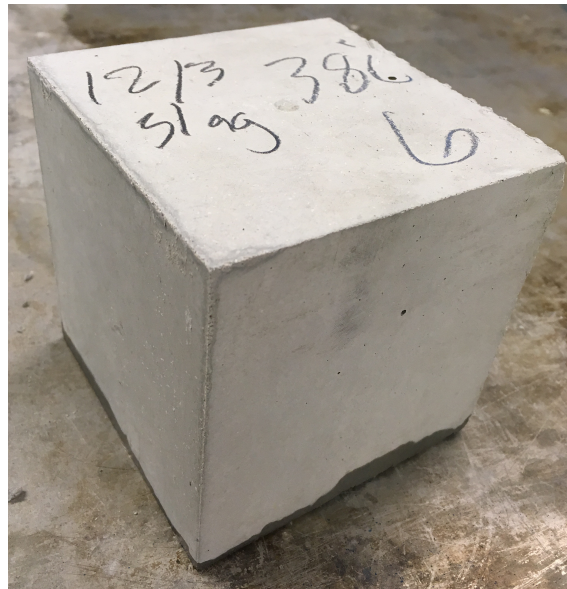
Figur 4.1: Prøvestykke fra resept Slagg 0,55 før testing [Foto: Anders Raastad Elgen]
