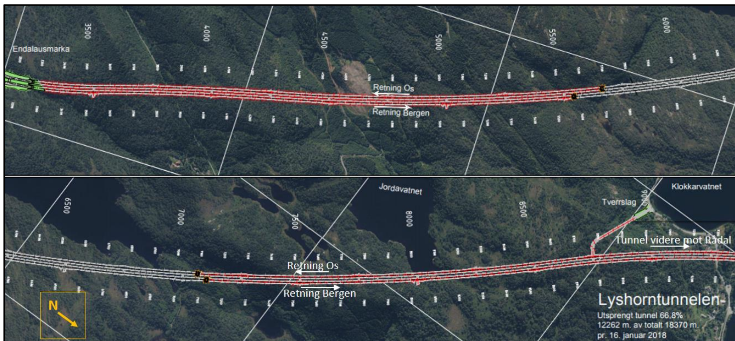
Figur 9.13: Fremdrift i Lyshorntunnelen pr. januar 2018. Området markert med rødt indikerer utsprengt tunnel. Øverste del av bildet viser tunnelstrekningen som drives fra Endalausmarka, hvor tunnelvannet slippes til Kvernatjørna. Nederste bilde viser
