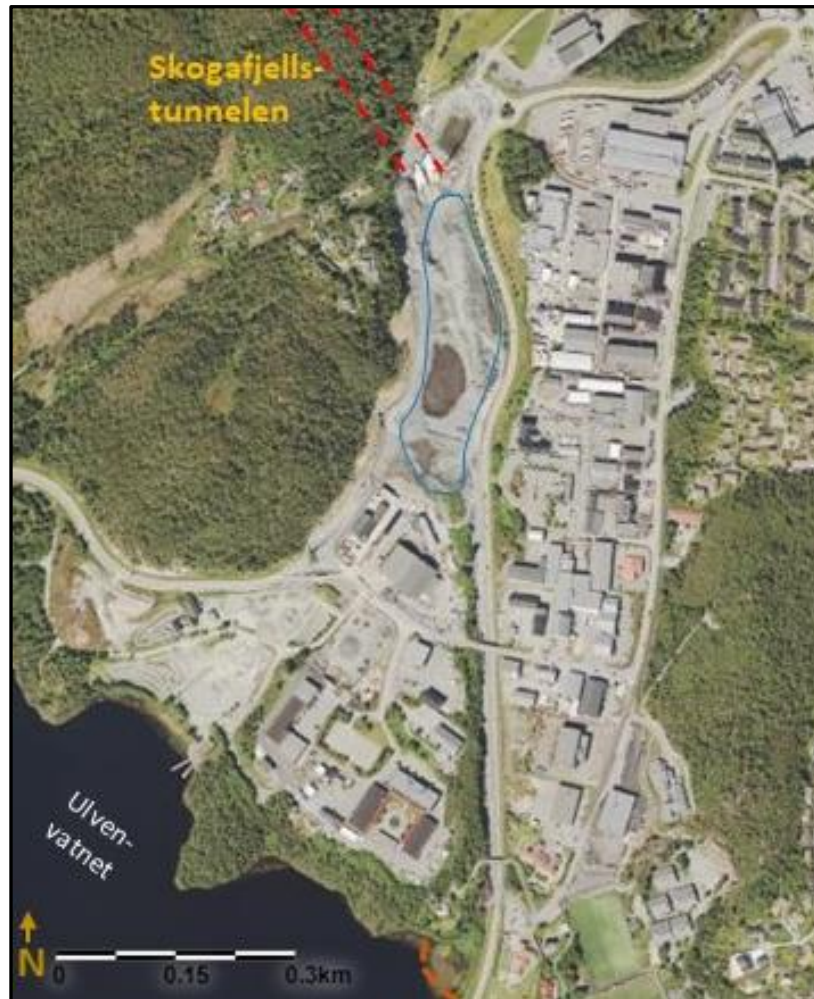
Figur 9.9: Oversikt over fremdrift ved Svegatjørn pr. juli 2017. Skogafjellstunnelen er ferdig utsprengt. Svegatjørn er her tømt og fylt med sprengstein fra Skogafjellstunnelen. Originalt omriss av Svegatjørn er vist med blå strek. Oransje stiplet linje indikerer siltgardinen i Ulvenvatnet. Kartgrunnlag er hentet fra http://www.norgebilder.no/ , og deretter modifisert (Hentet 27. januar 2018).
