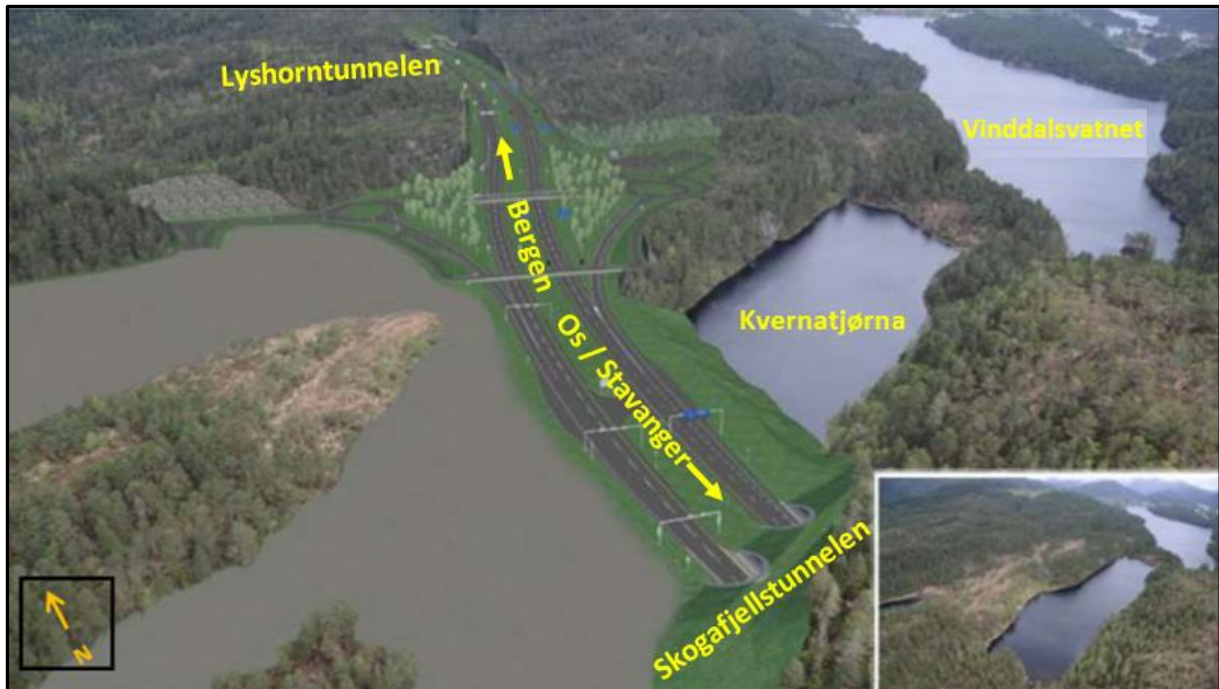
Figur 9.11: Oversiktsbilde med inntegnet ferdig veianlegg i Endelausmarka. Kvernatjørna er her delvis fylt igjen. Planlagte massedeponier er vist til venstre i figuren som grå-brune felt. Området før påbegynt veianlegg er vist i høyre hjørne. Modifisert etter Statens vegvesen (2017a), målestokk var ikke inkludert i original figur.
