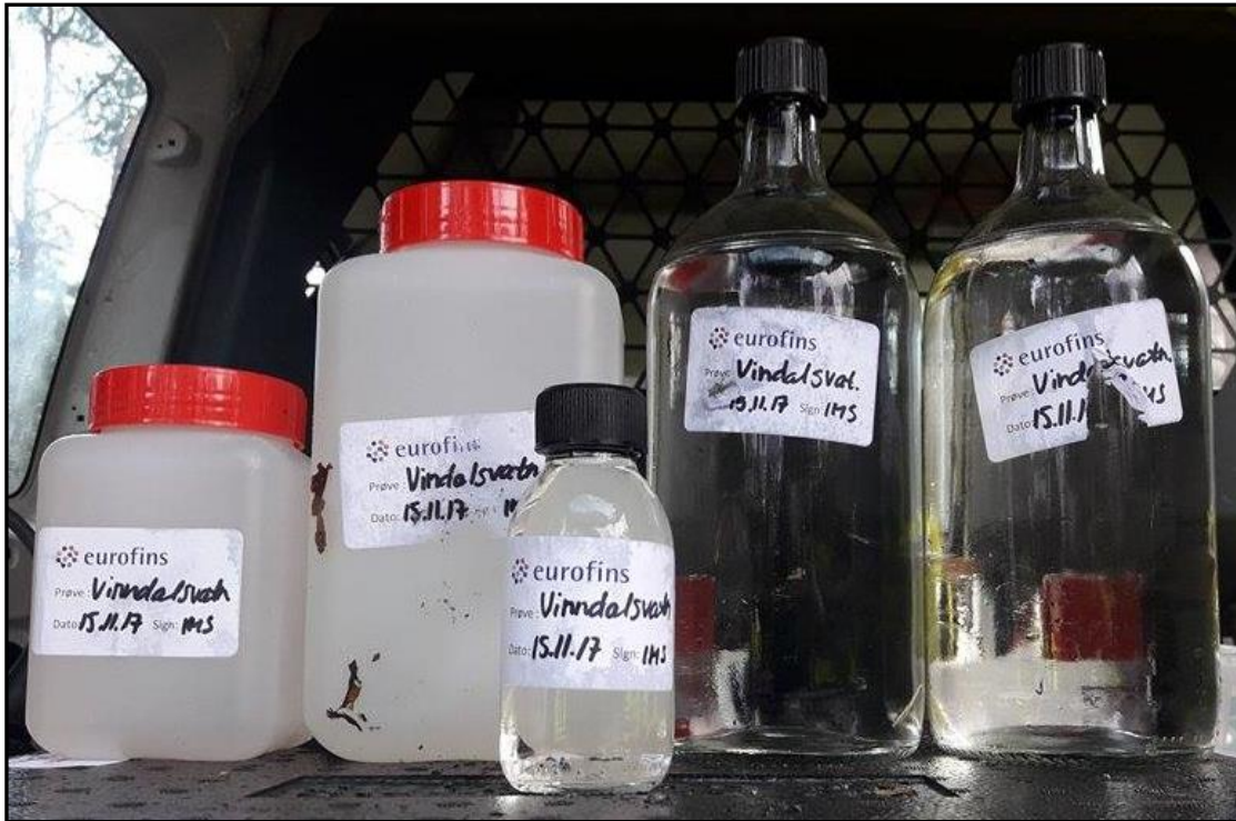
Figur 10.4: Oversikt over beholdere for prøvetaking. To plastflasker (0,5- og 1 L), en liten glassflaske og to 1-literflasker i glass med vannprøver fra Vinddalsvatnet. (Foto: Sunniva Lunestad, 15. november 2017).
