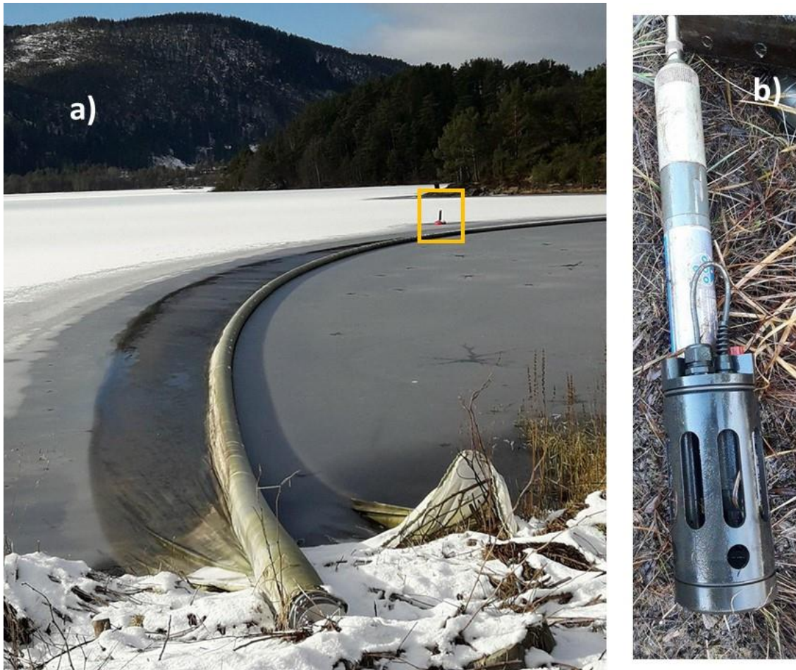
Figur 10.6: Utstyr for kontinuerlig overvåkning av vannkvalitet med online logger, samt plassering av logger i Ulvenvatnet a) Online logger i Ulvenvatnet er om lag 6 m utenfor siltgardinen (gul firkant). Bøye, batteripakke og sender er synlig over vannflaten. (Foto: Sunniva Lunestad, Ulvenvatnet 22. februar 2018). b) Foto av sensorer som plasseres i vannmassen. (Foto: Sunniva Lunestad, Ospelitjørn 15. november 2017).
