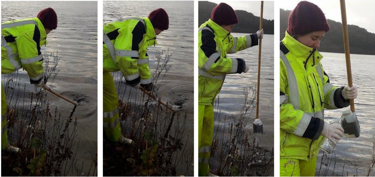
Figur 10.5: Eksempel på gjennomføring av prøvetaking av overflatevann ved bruk av plastflaske (0,5 L) med påmontert treskaft. Bildet er tatt under prøvetaking ved Ulvenvatnet (Foto: Ingeborg Solvang, 15. november 2017).
