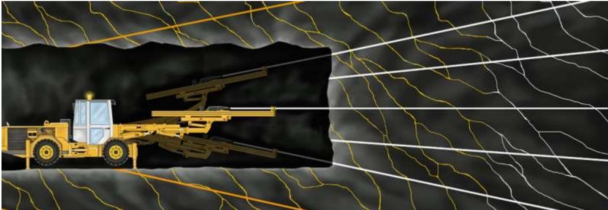
Figur 2.2: Boring av skjerm til forinjeksjon. Legg merke til tidligere hull og fylte sprekker (gult fyll) (Statens Vegvesen, 2011).
