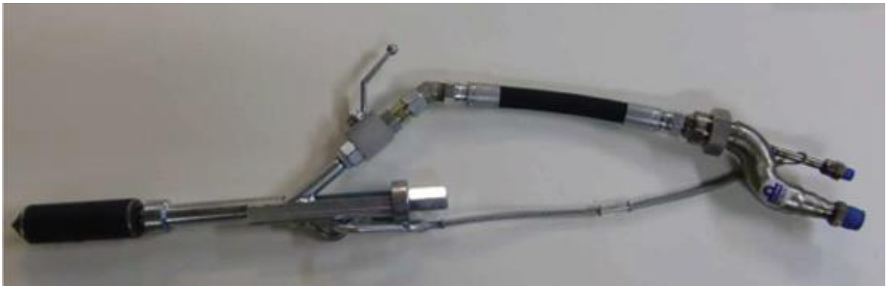
Figur 2.4: Pakker (til venstre) festet til injeksjonsstav. Munnstykke for akseleratorbruk på toppen (Hognestad et al., 2010).
