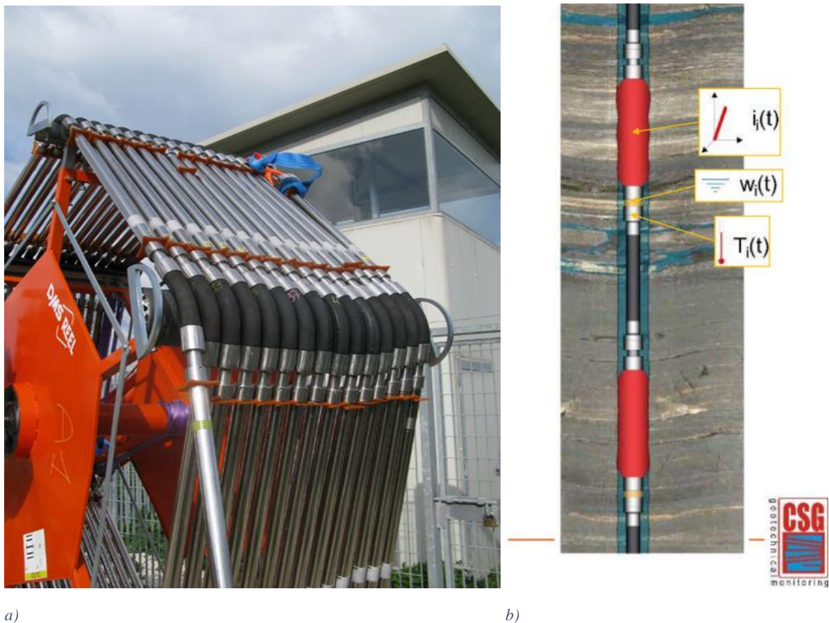
Figur 3.1: Illustrasjon av a) DMS-moduler (grå) sammenkoblet med ledd (svart) (CSG, u.å.a), og b) moduler installert i fjell, med indikerte målesensorer for deformasjon ( i_i(t) ), grunnvannsnivå ( w_i(t) ) og temperatur ( T_i(t) ) (Lovisolato, 2017). Mellom modulene og foringsrøret settes en ringformet gummi (rød) for godt feste (b) (Lovisolato et al., 2003).
