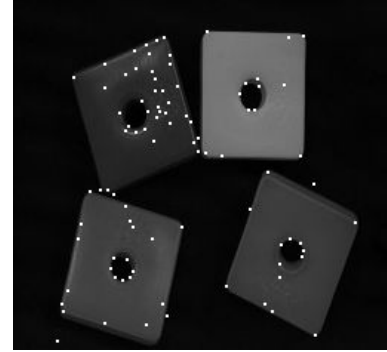
Figur 4.7: Oppdagede punkter: Förstnerdetektoren
