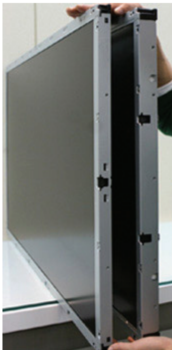
Figur 48 – Eksempel på flatpanel. 42" LCD-panel, helt nytt panel til venstre og litt tykkere gammelt panel til høyre.
