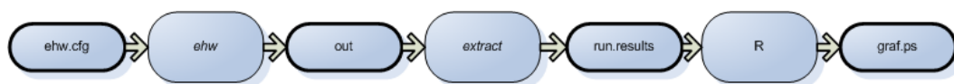
Figur 4.1: En parameterfil sendes inn i programmet ehw , som skriver resultatet til en fil. Denne filen blir lest inn i programmet extract , som ekstraherer relevant statistikkdata og legger det i en ny fil. Denne filen blir lest inn i et R-skript, som produserer en fil med en grafisk framstilling av dataene.
