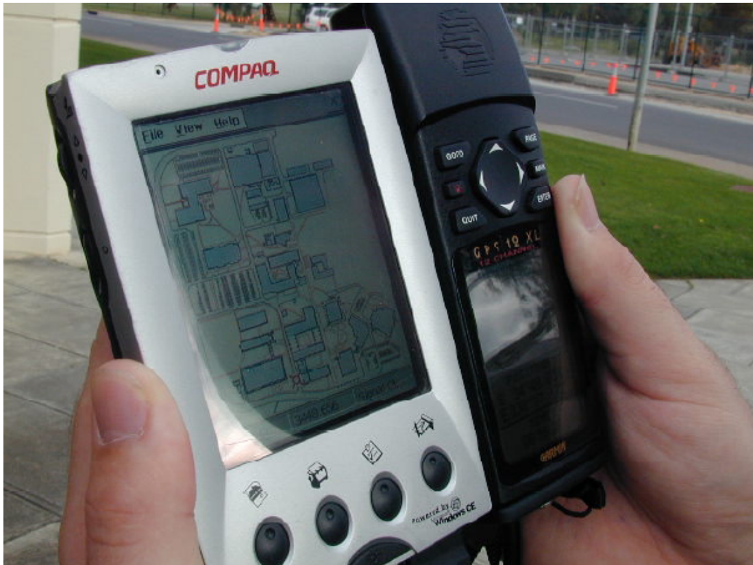
Figur 7: Klientenheten til TouristGuide, en PDA, koblet til en håndholdt GPS
