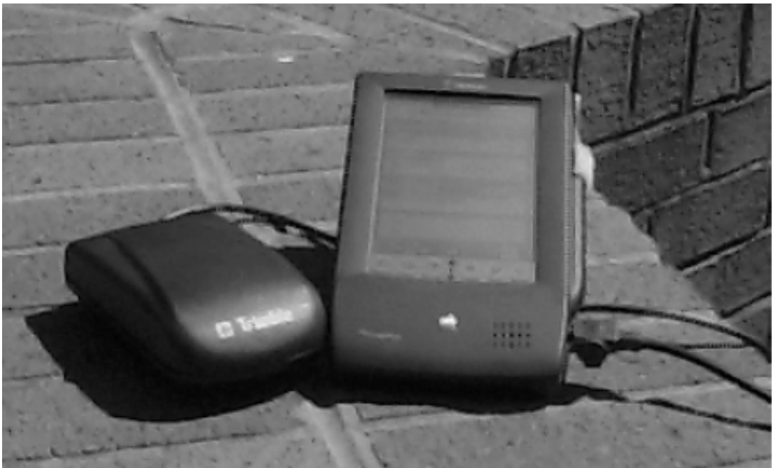
Figur 15: CyberGuide klientenhet Apple MessagePad med GPS-enhet
