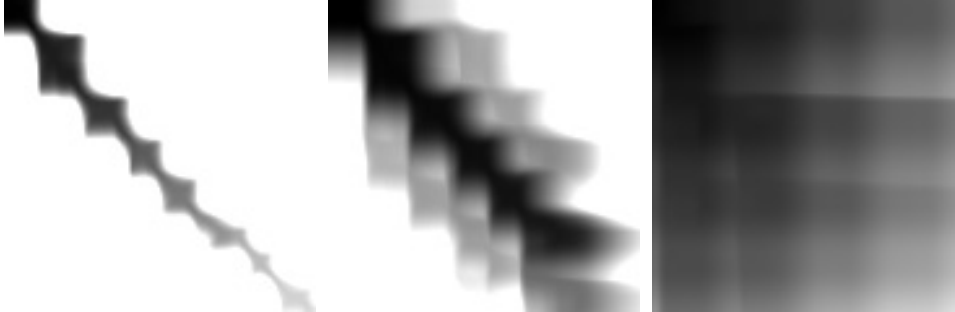
Figur 12: Tre eksempler på ”høydekart”. Fra venstre: god korrelasjon, god korrelasjon i starten og dårlig på slutten, totalt ukorrelert. Alle er normalisert på verdien i D(|X|, |Y|) (som vil si punktet nederst til høyre) og invertert.
