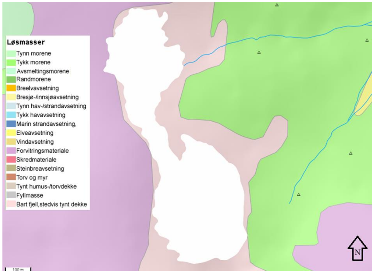
Figur 2.5: Oversikt over løsmasser ved Storbrean. De små trekantene er en indikator på høyt blokkinnhold. Hentet fra NGU http://geo.ngu.no/kart/losmasse/
