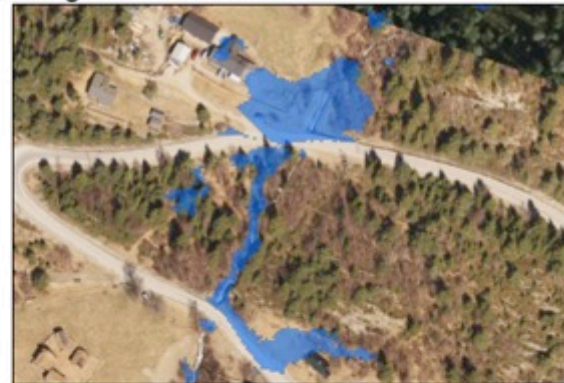
Blokkerte kulverter, med grid og forbedret tverrsnitt
