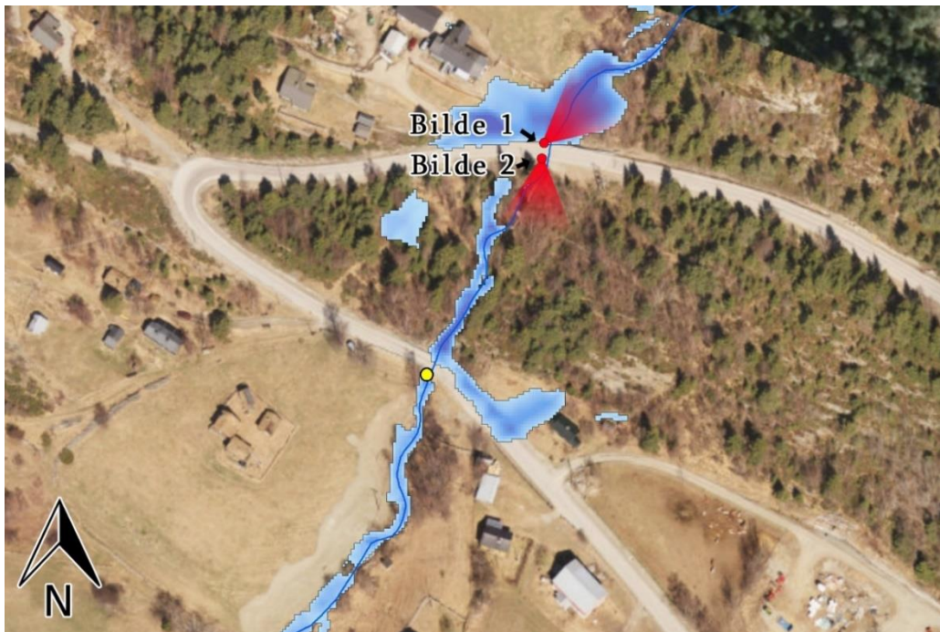
Figur 5-7: Vannstand ved 2,8 \text{ m}^3/\text{s} vannføring med TIN som terrengmodell. Røde punkter angir hvor bildene er tatt, gult punkt er skadepunktet (Ortofoto: Norgebilder.no, juni 2017).
