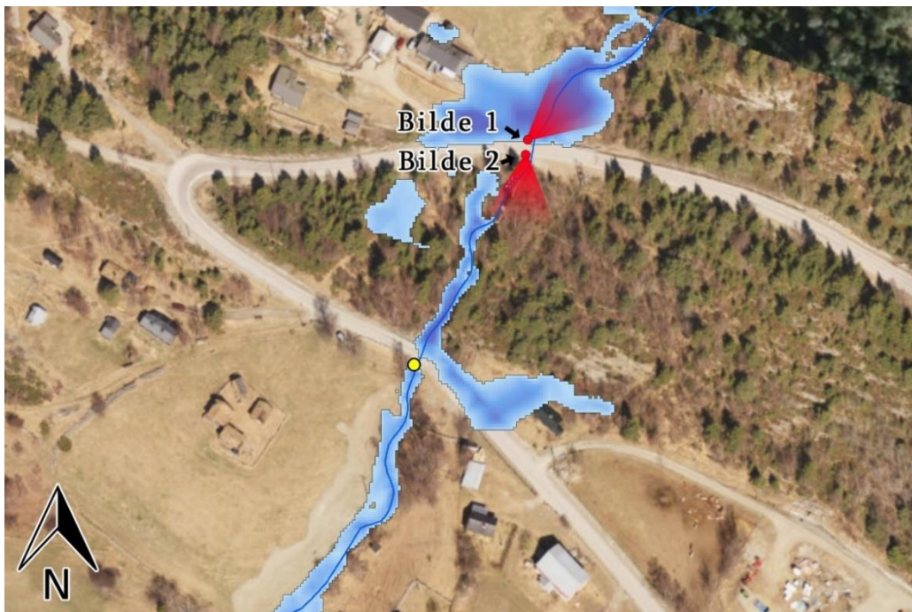
Figur 5-8: Vannstand ved 6 \text{ m}^3/\text{s} vannføring med TIN som terrengmodell (Ortofoto: Norgebilder.no, juni 2017).
