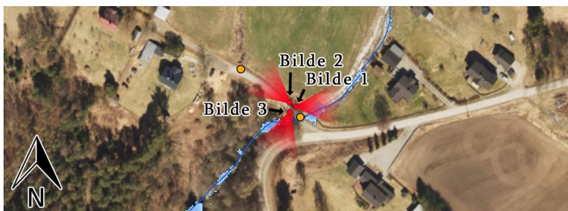
Figur 5-38: Vannstand ved 2,8 m 3 /s vannføring med GRID som terrengmodell. Røde punkter angir hvor bildene er tatt, oransje punkter er skadepunkter (Ortofoto: Norgebilder.no, juni 2017).
