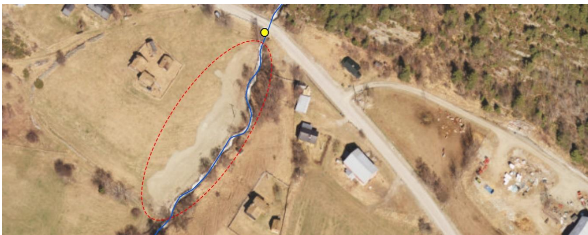
Figur 5-6: Mulig spor av plastringen etter flommen i 2013 nedenfor skadepunktet (Ortofoto: Norgebilder.no, juni 2017)
