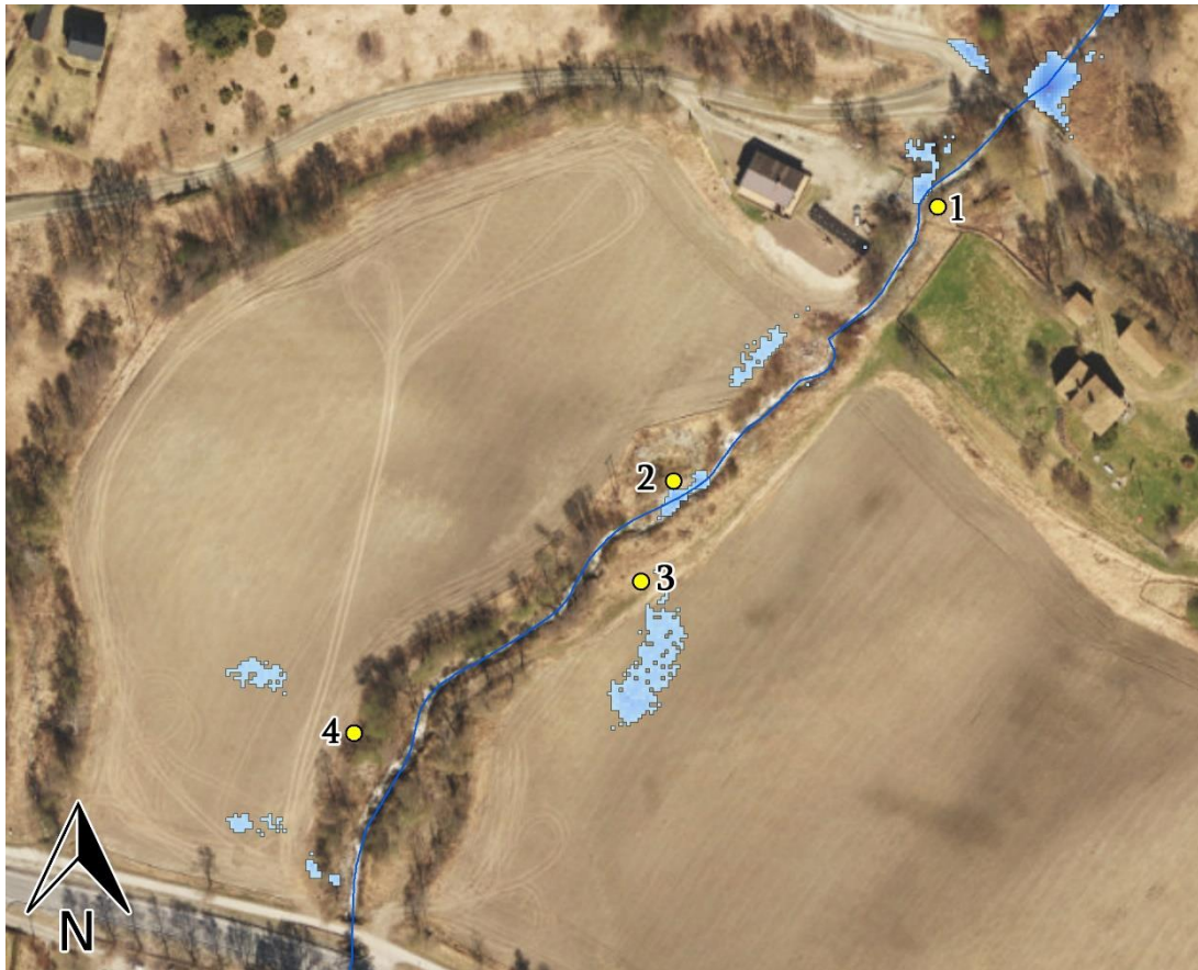
Figur 5-29: Vannstand ved 6 m 3 /s vannføring med GRID som terrengmodell (Ortofoto: Norgebilder.no, juni 2017).
