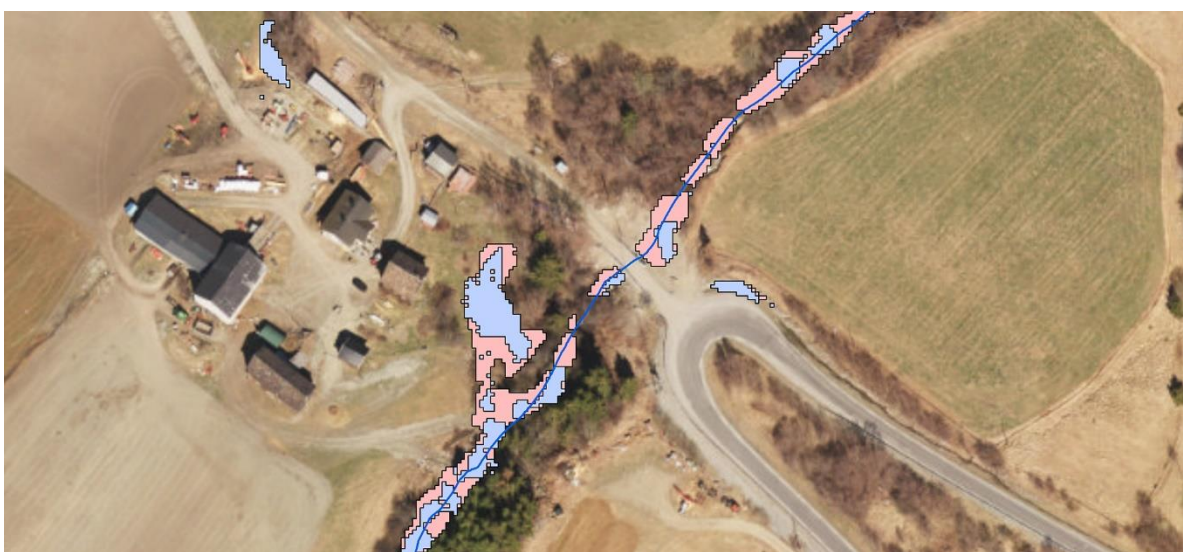
Figur 5-22: Sammenligning av modellene ved vannføring på 2,8 m 3 /s. GRID-modellen i blått lagt oppå TIN-modellen i rødt (Ortofoto: Norgebilder.no, juni 2017).
