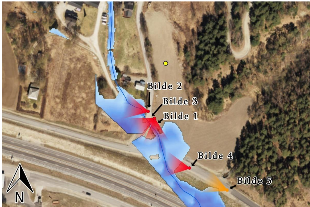
Figur 5-45: Vannstand ved 2,8 \text{ m}^3/\text{s} vannføring med TIN som terrengmodell. Røde punkter angir hvor bildene er tatt, oransje punkt er antatt plassering av bilde 5, gult punkt er skadepunktet (Ortofoto: Norgebilder.no, juni 2017).
