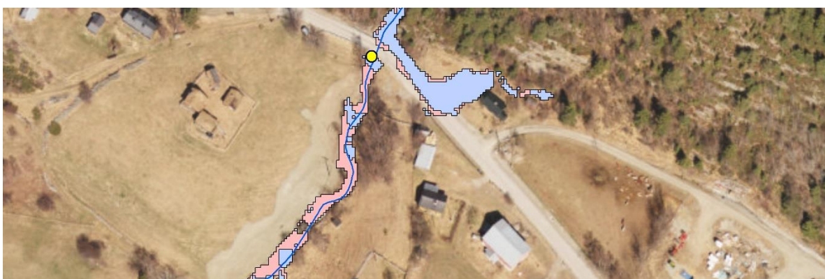
Figur 5-13: Detalj av område 1 nedstrøms for skadepunktet. GRID-modellen i blått lagt oppå TIN-modellen i rødt ved vannføring på 2,8 \text{ m}^3/\text{s} (Ortofoto: Norgebilder.no, juni 2017).
