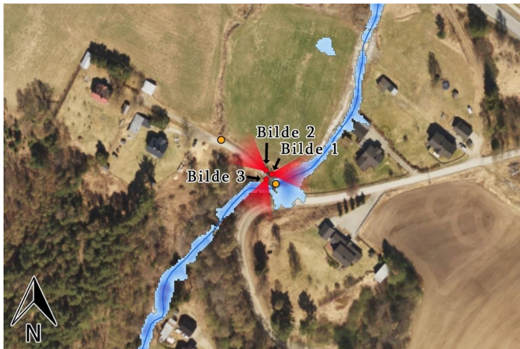
Figur 5-36: Vannstand ved 6 \text{ m}^3/\text{s} vannføring med TIN som terrengmodell (Ortofoto: Norgebilder.no, juni 2017).
