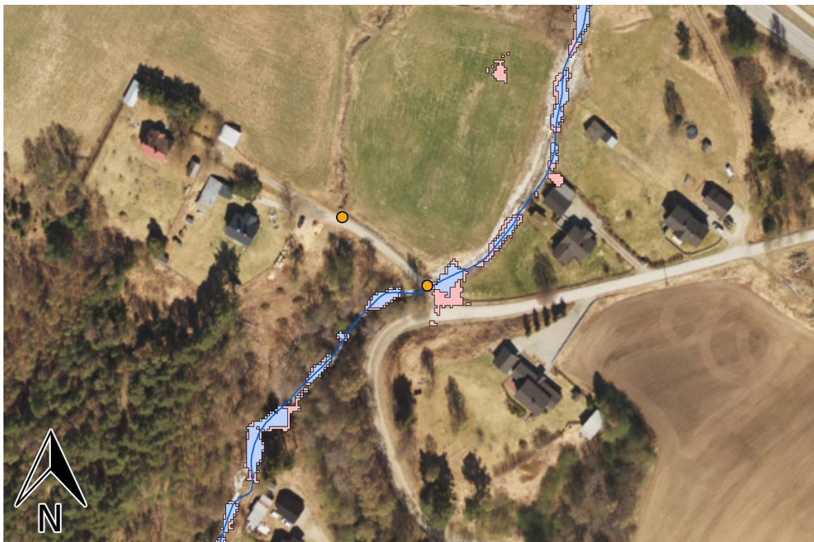
Figur 5-40: Sammenligning av de to GRID-modellene. Vannstand ved 2,8 m 3 /s i blått lagt oppå 6 m 3 /s i rødt (Ortofoto: Norgebilder.no, juni 2017).
