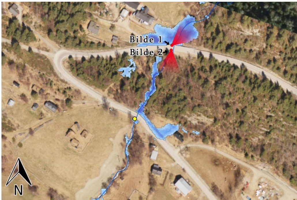
Figur 5-10: Vannstand ved 2,8 \text{ m}^3/\text{s} vannføring med GRID som terrengmodell. Røde punkter angir hvor bildene er tatt, gult punkt er skadepunktet (Ortofoto: Norgebilder.no, juni 2017).
