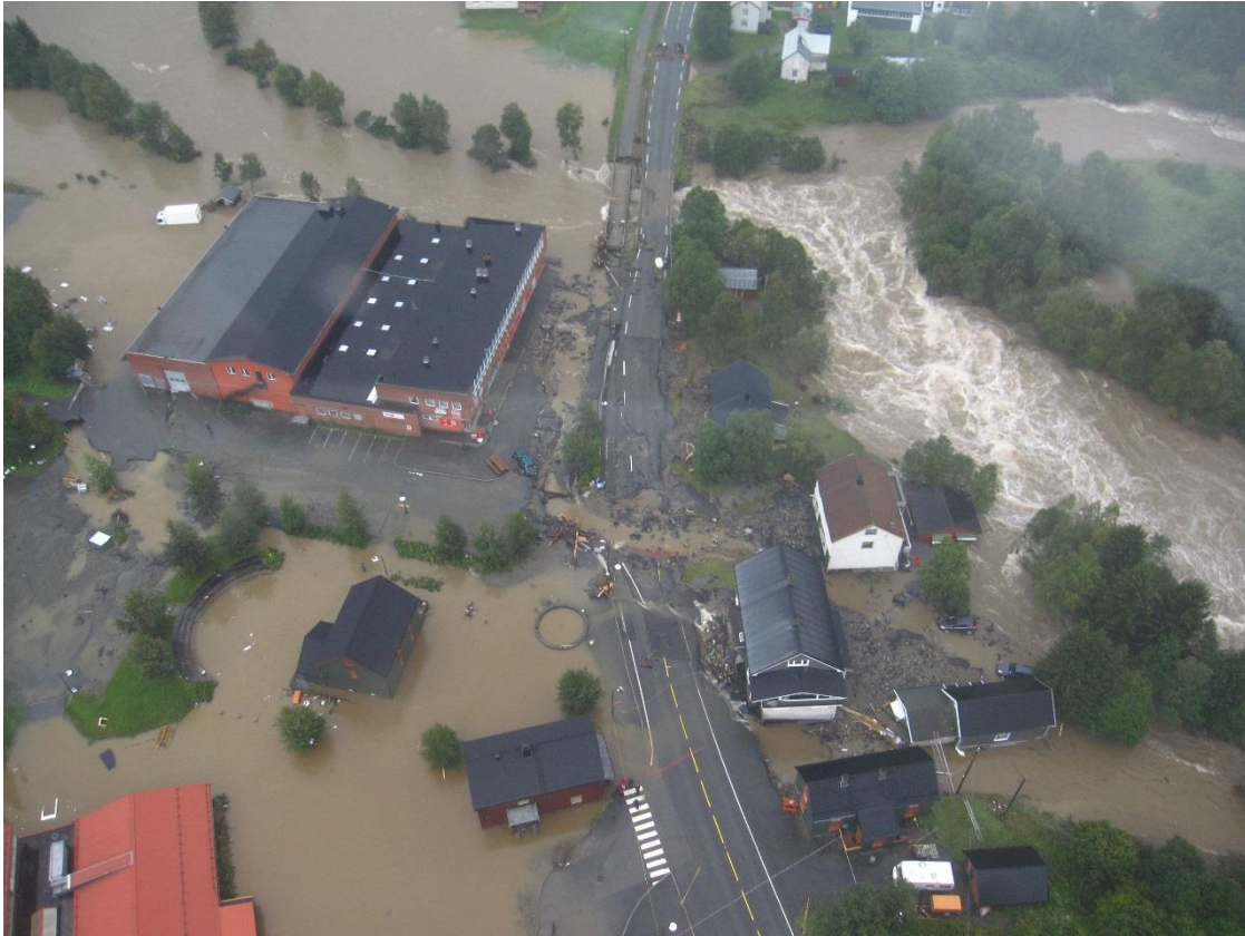
Figur 9: Ålen sentrum. Lund bru hadde for liten kapasitet til å avlede elva, og førte til oversvømmelser i sentrum. Bildet er tatt klokken 08.00 tirsdag 16. august. Foto: Anna Lian
