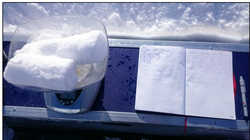
Figur 6 og 7: Bildene viser uttak av snøkjerner som veies og dokumenteres. Foto: Privat
