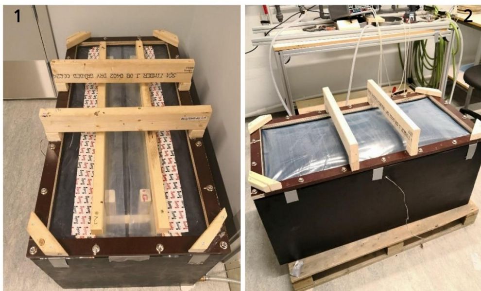
Figur 23 Trykktesting av prøve (1) og trykktesting av boksens egenlekkasje (2)
