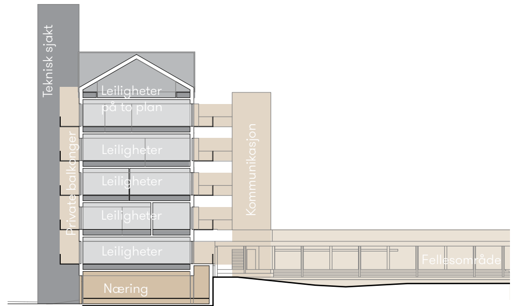
Prinsippsnitt av tekniske føringer i dobbeltgulvet mellom hver etasje, som gir fleksibilitet i planløsning og nivåforskjeller.
