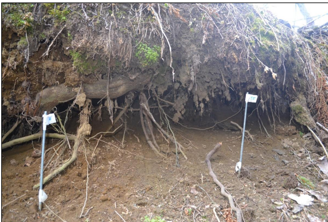
Figur 94: Eksempel på underkutting, venstre skråningsside (Økland, 03.05.2016)
