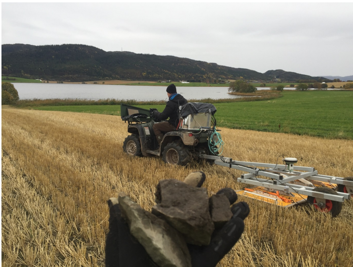
Figur 3: Datainnsamling i praksis. Georadarutstyret består av et antennesystem montert på et tilhengerfeste, som så blir trukket bak et kjøretøy med tilhengerfeste. Legg også merke til de skjørbrente steinene funnet på jordet. Foto: Arne Anderson Stamnes, NTNU Vitenskapsmuseet.
