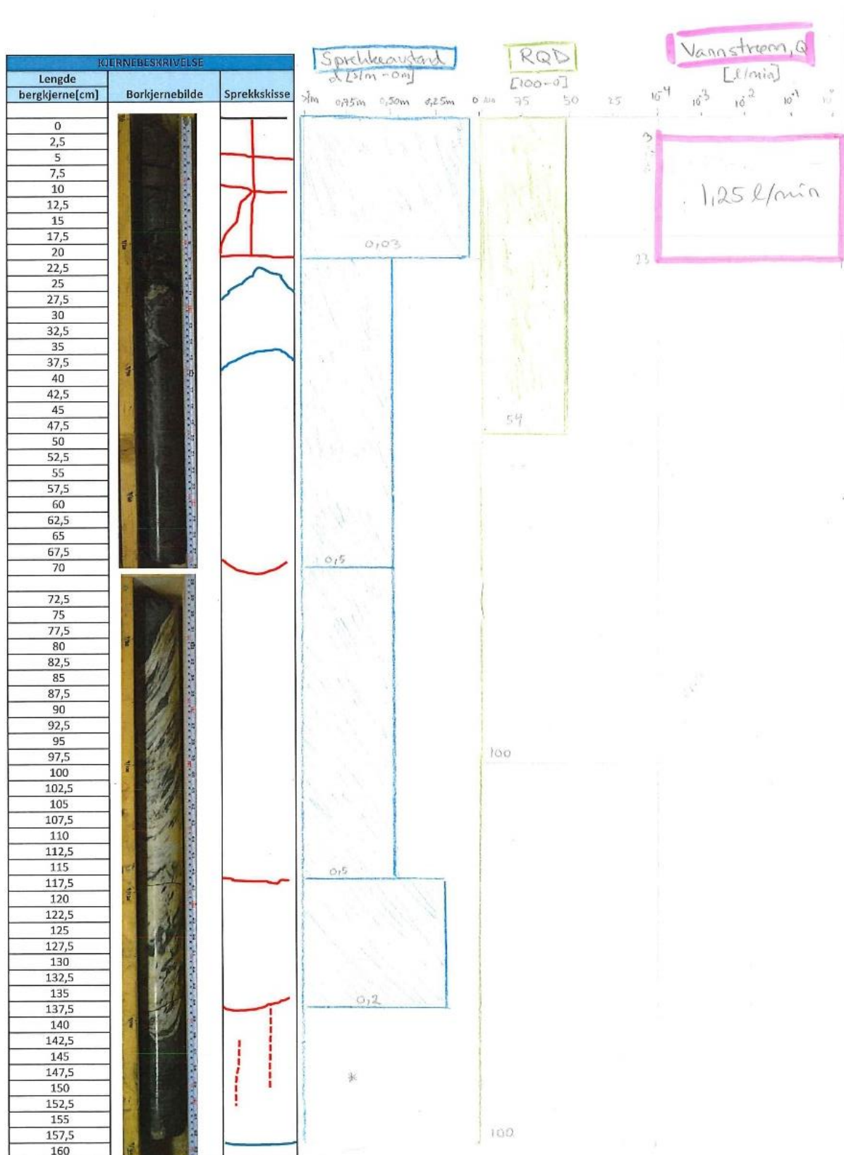
Figur 42: Borkjernelogging for borhull 9. Høy vannstrøm i oppsprukket sone.
