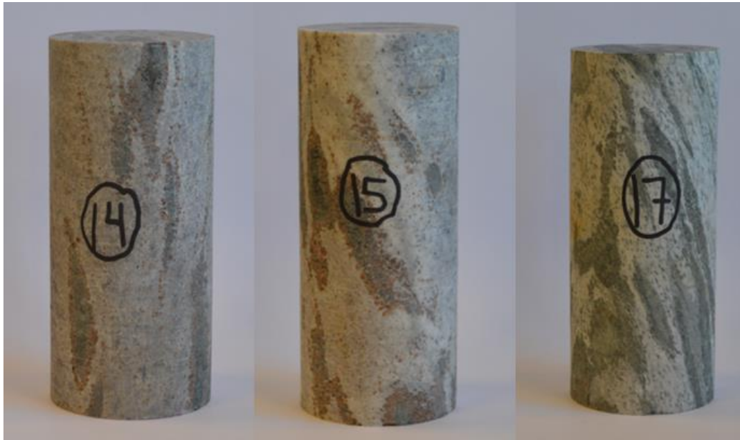
Figur 82: Prøve 14, 15 og 17 fra borhull 10 på Arna-siden. Prøve 14 og Prøve 15 er korona anortositt, mens prøve 17 er anortosittisk gneis.
