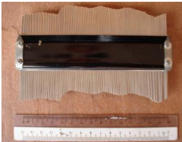
Figur 31: Redskap brukt under fremstilling av sprekkenes ruhet (JRC).
