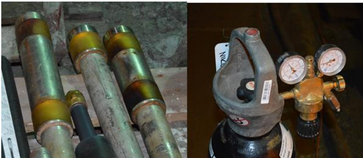
Figur 34: Utstyret bruk til hydrauliske målinger. Øverst: Registreringsutstyret med vanntank. Nederst til venstre: Mansjetter med forskjellige lengder på seksjonene. Dobbeltpackerne har seksjoner på 10cm og 20cm, Enkeltpackeren har valgbar seksjonslengde. Måler innerst i borhullet. Nederst til høyre: Nitrogentank for trykkoppbygging.
