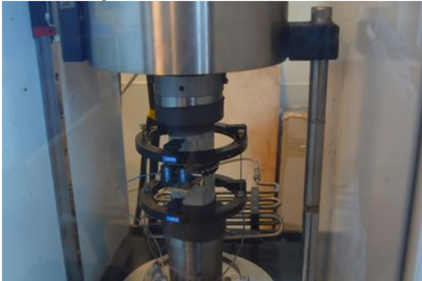
Figur 691: Trykkcelle brukt for UCS-test
