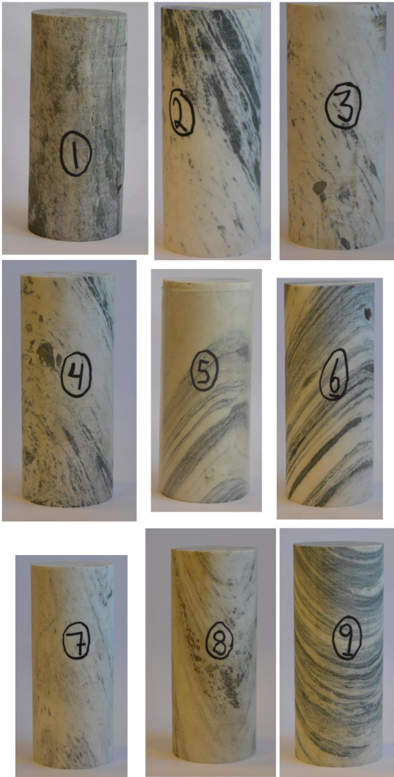
Figur 66 Kjerner fra Arna-siden. Kjernennummer 1-9. Obs: Kjerne nummer 1 er tatt bilde av etter UCS-test.
