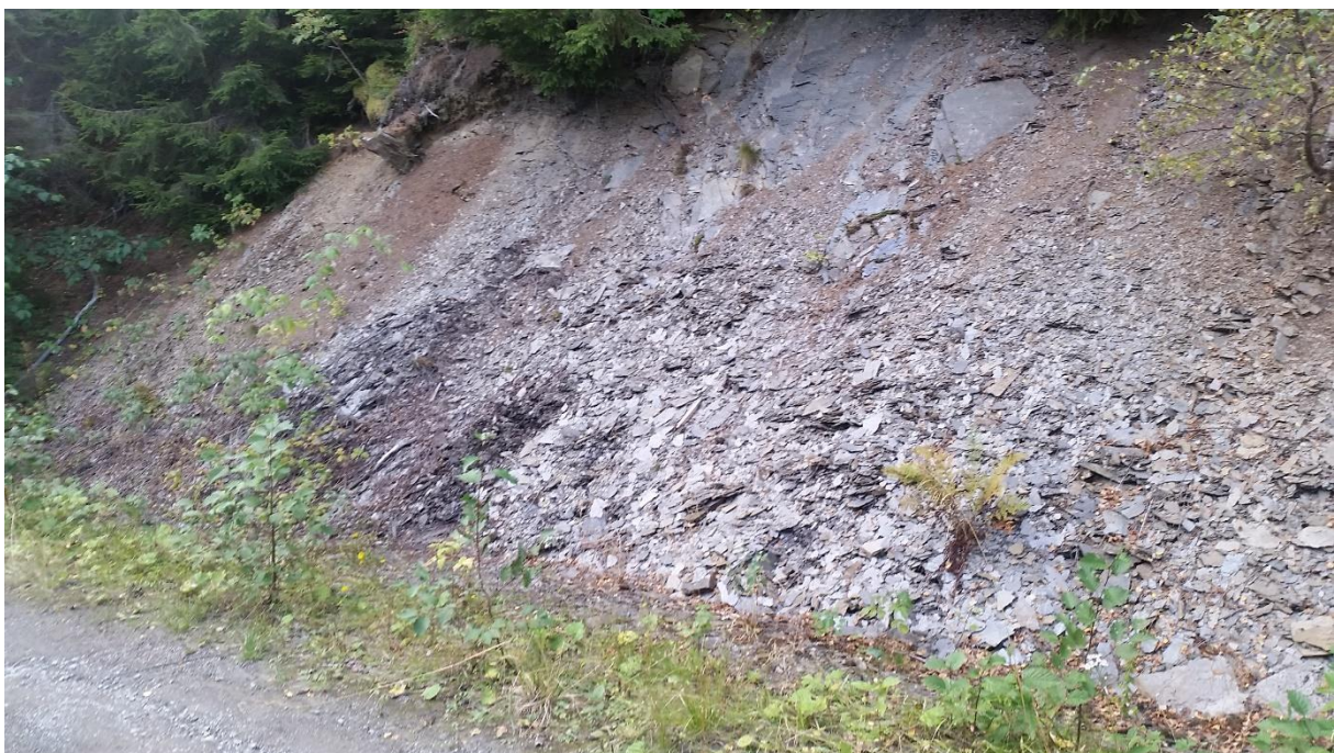
Figur 42: Eksempel på forvittringsmateriale frå lokal skifrig berggrunn. Materialet er nokså grovt i overflata, men blir progressivt finare lengre ned. Organisk materiale og finstoff i forvittringsmateriale kjem sannsynlegvis frå morene og grantrø over skråninga, noko som kan forklare dei hengande røtene i øvre del av bildet. Vidare nedbryting av skifer kan og forklare noko av dei finare partiklane. Foto er tatt ved punkt 046, mot vest – nordvest (Dato: 20.09.2017).
