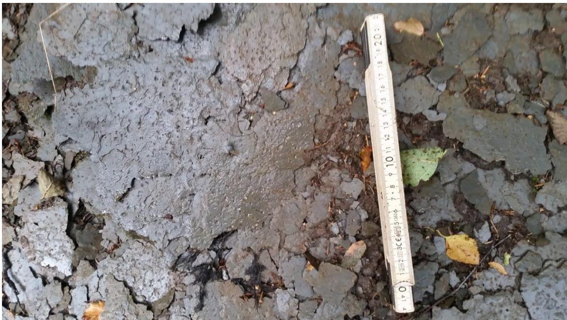
Figur 40: Foto av skiferbergart frå feltområde. Bergarten viser ein dominerande grå farge, med eit matt skin, og er veldig oppsprukken. Delar av skinet kjem frå fukt på fragmenta frå tidlegare nedbør, medan resten er tolka til å kome frå glimmermineral. Som ein ser, så er overflata dekt av små «prikkar» som blir utgjort av mindre jernhaldige mineral. Krystallane er kubiske, og er mistenkt til å vere pyritt. Bildet er tatt mot nordvest ved punkt 016 (Dato: 13.09.2017).
