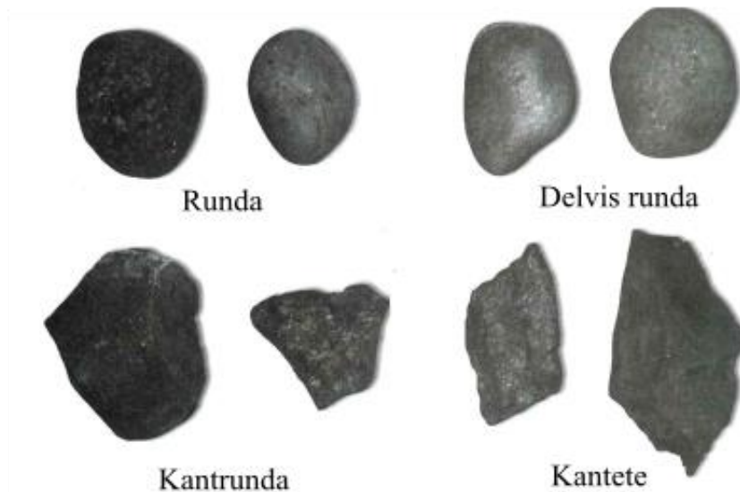
Figur 4: Eksempelbilde på partiklar med ulike grad av rundingsgrad ( roundness ). Modifisert frå Holtz, Kovacs og Sheahan (2011).
