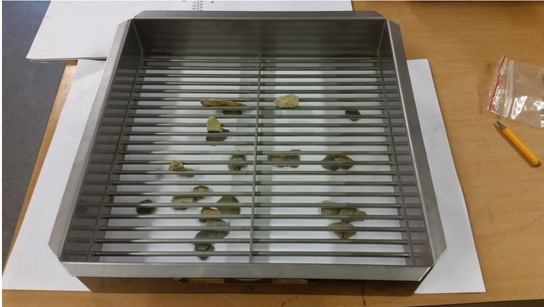
Figur 29: Stavsikt nytta til måling av flisigheits-indeks. Siktet består av parallelle rader med sylindriske stavar, i staden for kryssgåande variantar slik ein har med vanlege sikt. Spaltene mellom stavane er designa til å ha ei breidde tilsvarande halvparten av øvre kornstørrelse for siktet, til dømes at eit sikt med øvre grense på 20 mm har ei spaltebreidde lik 10 mm. I figuren kan ein sjå resultatet av sikting innan fraksjonen 16 – 12.5 mm, med ei spaltebreidde på 8 mm (30.10.2017).
