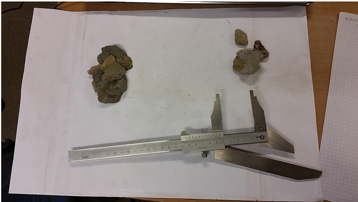
Figur 30: Bilde av skyvelære brukt til måling av form-indeks, samt ferdig prosessert fraksjon. Alt materiale vart først målt i den opne spalta langs målestokken (Øvre del av apparatet). Deretter vart partiklane forsøkt ført gjennom spalta nedst i bildet. Passerte den gjennom denne, vart partikkelen lagt i ein haug saman med andre som hadde passert, medan resterande materiale vart lagt i ein annan haug. Her kan ein sjå passerte partiklar til venstre, og restmateriale til høgre. (Dato: 31.10.2017)
