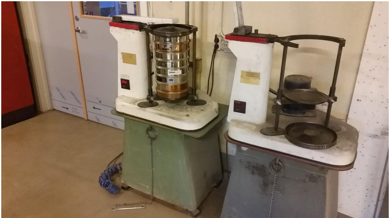
Figur 26: Siktmaskin på Ingeniørgeologisk lab hos IGP, som vart nytta til separasjon av lausmasseprøver til kornfordelingsanalyse. I dette bildet siktast Moreneprøve (S) nr. 1 med første siktesats ( Dato: 11.10.2017 ).
