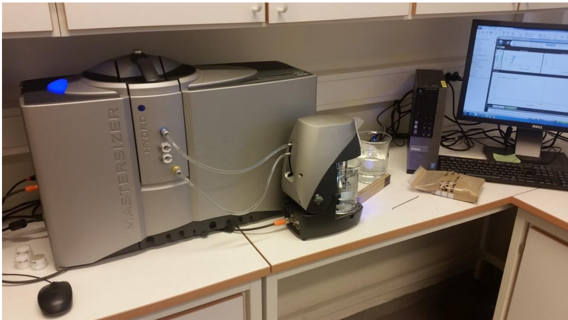
Figur 28: Bilde av oppsett nytta under laserdiffraksjonstest. Til høgre kan ein sjå ein prøvepose med materiale før blanding, ei tynn skeid som vart nytta til påfylling av materiale, ei glaskolbe brukt til reinsing av apparatet, og datamaskina som vart nytta til å styre prosessen og hente ut resultat. I midta kan ein sjå sjølve
