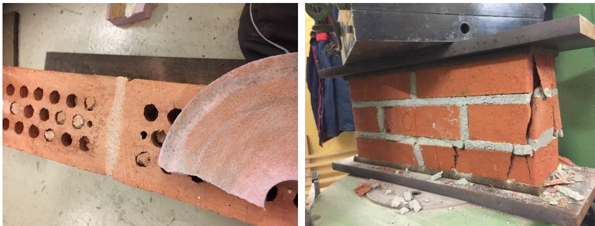
Figur 3. Sliping og trykking av prøvestykker
