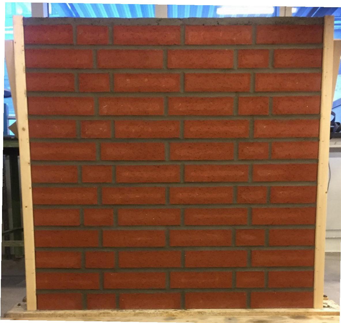
Figur 5. Nymurt felt (A) for slagregnforsøk viser fuktopptak i stein
