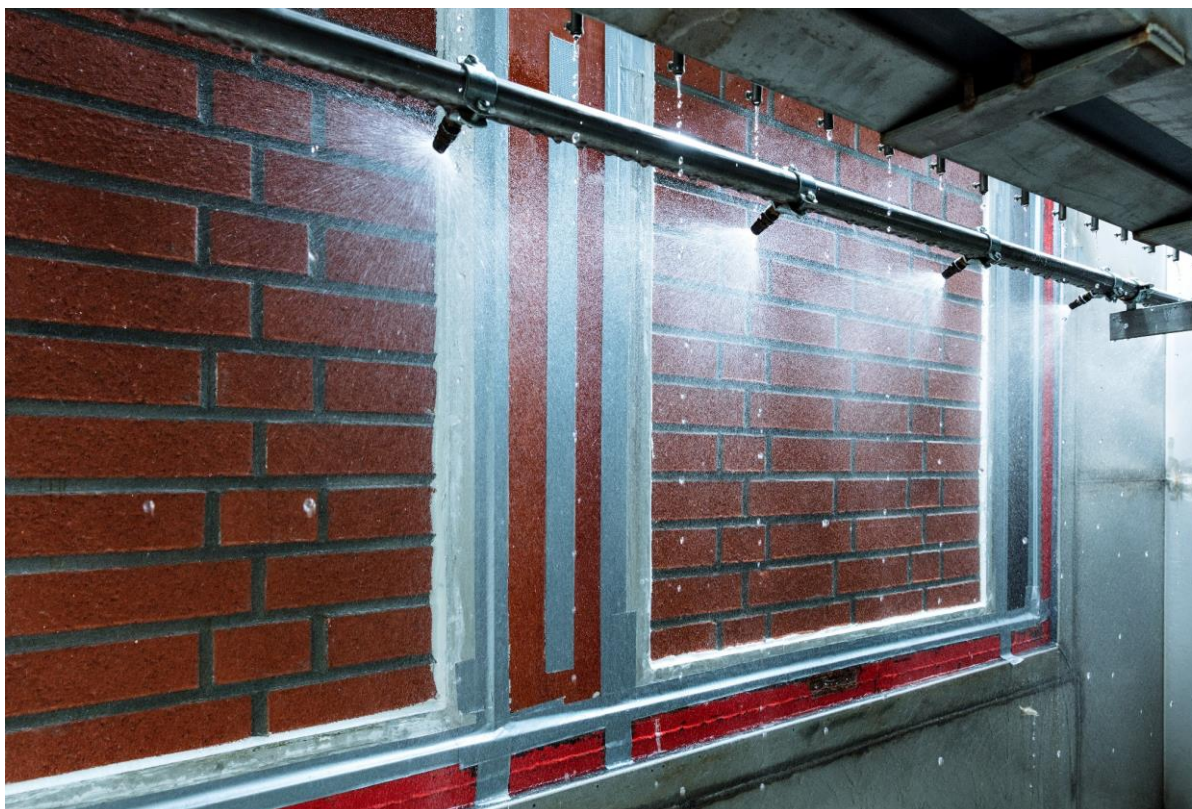
Figur 7. Veggfelt fra innsiden av slagregnskapet under forsøk. Foto: Geir Mogen
