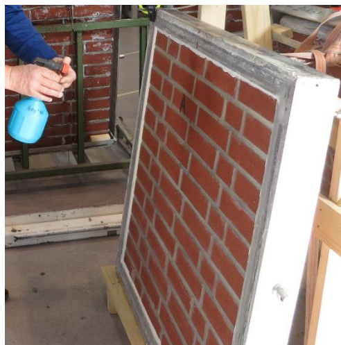
Figur 8. Impregnering. Foto: SINTEF
