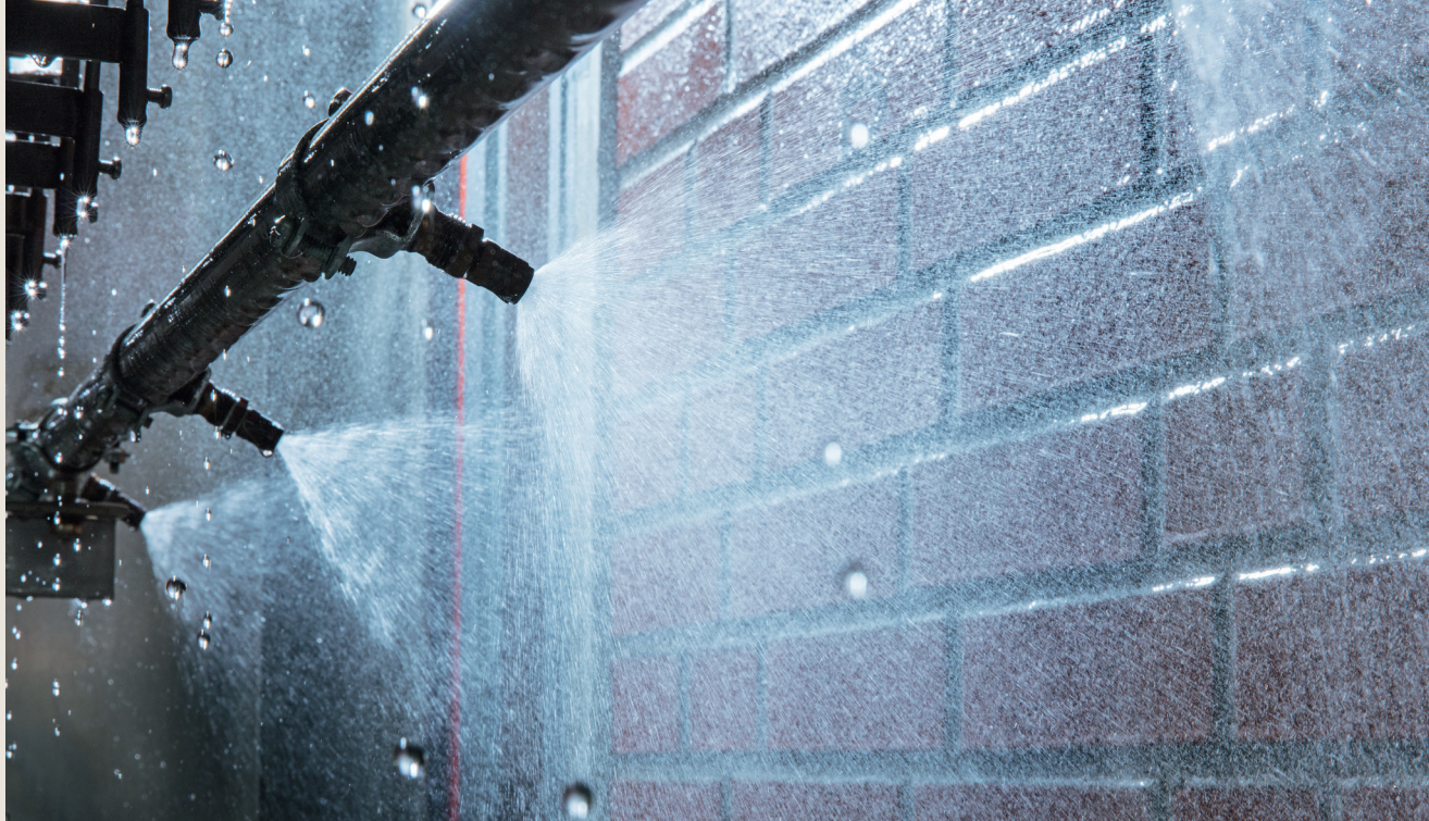
Den mest regntette teglfasaden oppnås ved muring med våt mørtel. Foto: Geir Mogen
