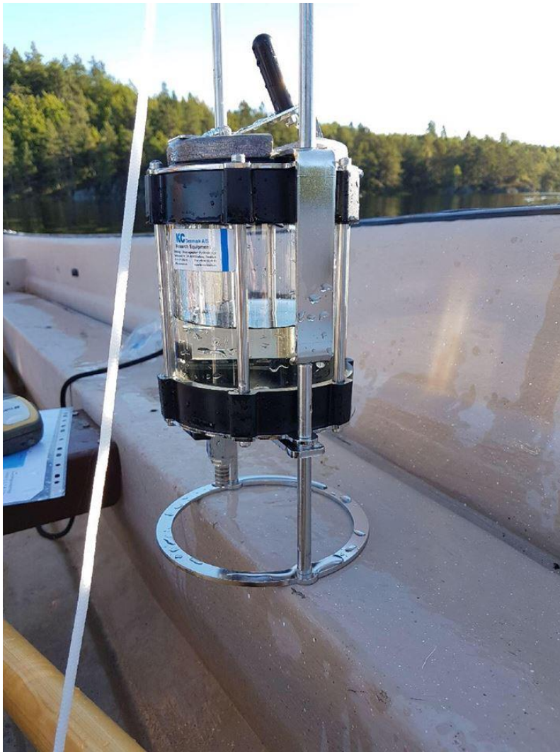
Figur 4.4: Bildet viser den ISO-sertifiserte prøvetakeren benyttet i Røynevannet for å ta prøver på ulike dybder ( Ruttner Water Sampler, KC-Danmark, Model 11.002 ) (Foto: Øyvind Mikkelsen)
