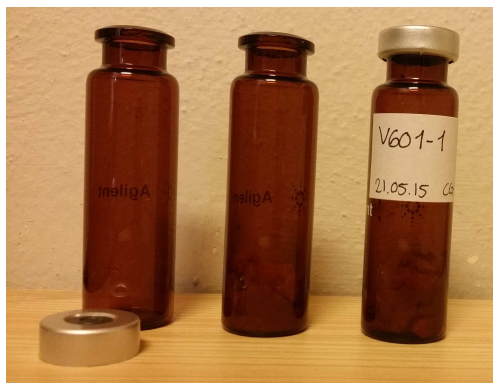
Figur 3.6: Preparering av prøver til headspace GC-MS. Til venstre: tomt prøveglass og kork, midten: prøveglass med ca. 4g makrell i tomat, til høyre: prøveglass med ferdig påkapslet kork. Foto: Christina Grønstad.
