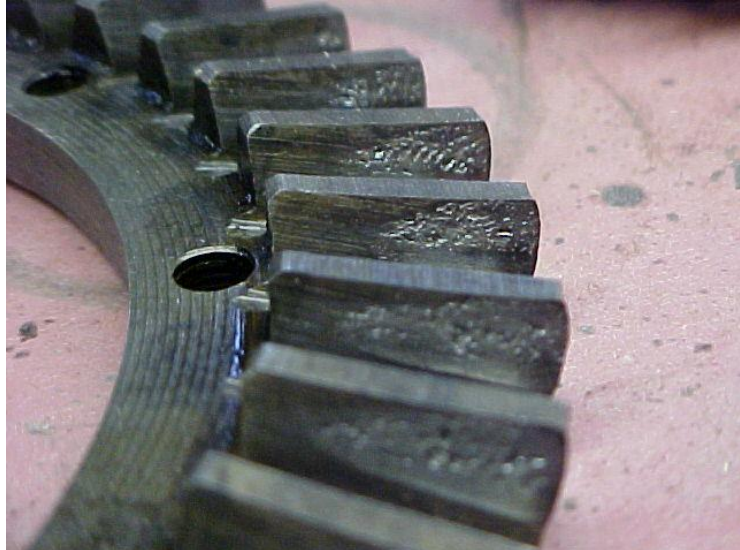
Figur 9 Gropdannelse (mtfca.com, feb 2015)
