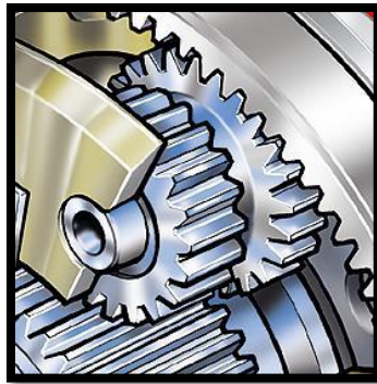
Figur 51 Doble planetehjul (kilde: http://en.wikipedia.org/wiki/Hub_gear , mai2015)
