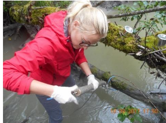
Figur 4.6 Montering av nye membraner ved SOR-2 (Åkesson, 2018).
