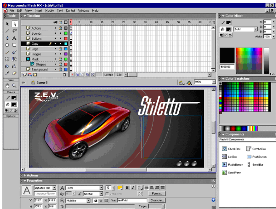
Figur 5.4 Hovedelementene i Flash er en design-editor, en kode-editor, en tidslinje, en verktøylinje og et komponentpanel med grafiske komponenter.
