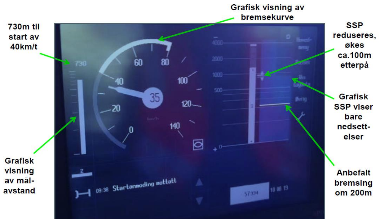
Figur 2.2 Førerpanelet ombord i toget med forklaring
