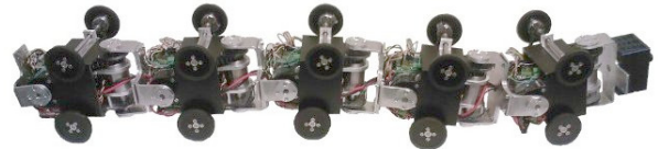
Fig. 1. The pipe inspection robot PIKo.
