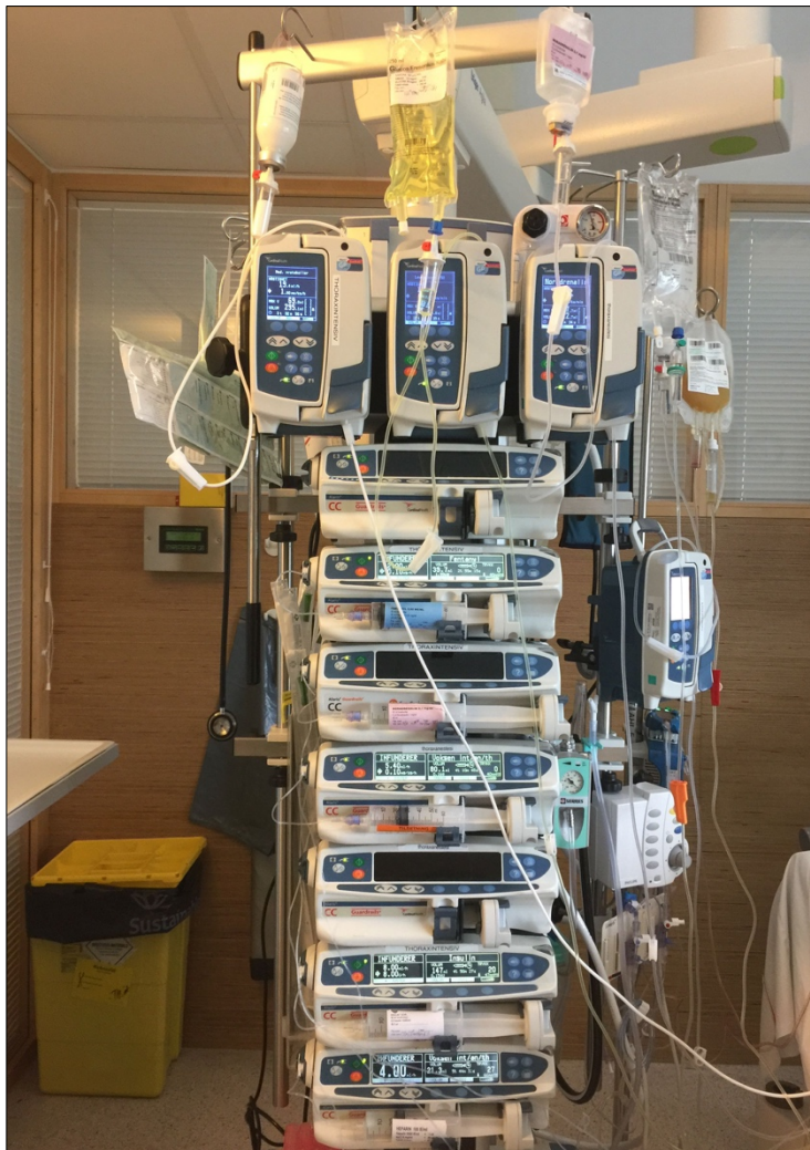
Figur 5.2: En rack med infusjons- og sprøytepumper.
