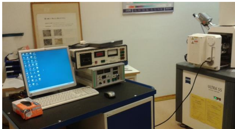
Figur 22: Styringsmaskin for strekkforsøk koblet inn i elektronmikroskopet
