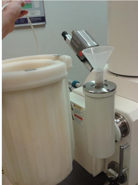
Figur 24: Termos montert på utsiden av elektronmikroskopet, påfylling av flytende nitrogen.
