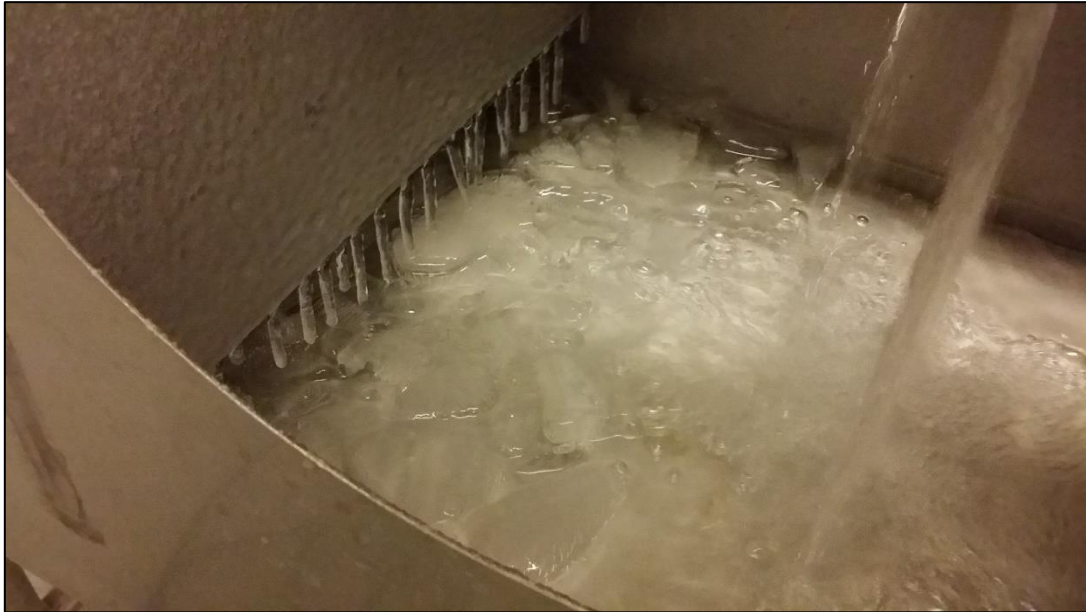
Figur 26 Vann gjennom rist og is i magasin ved kjøleromsforsøk
