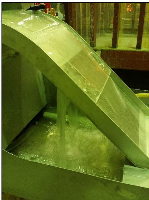
Figur 24 Vann over og gjennom snorkelmodell
