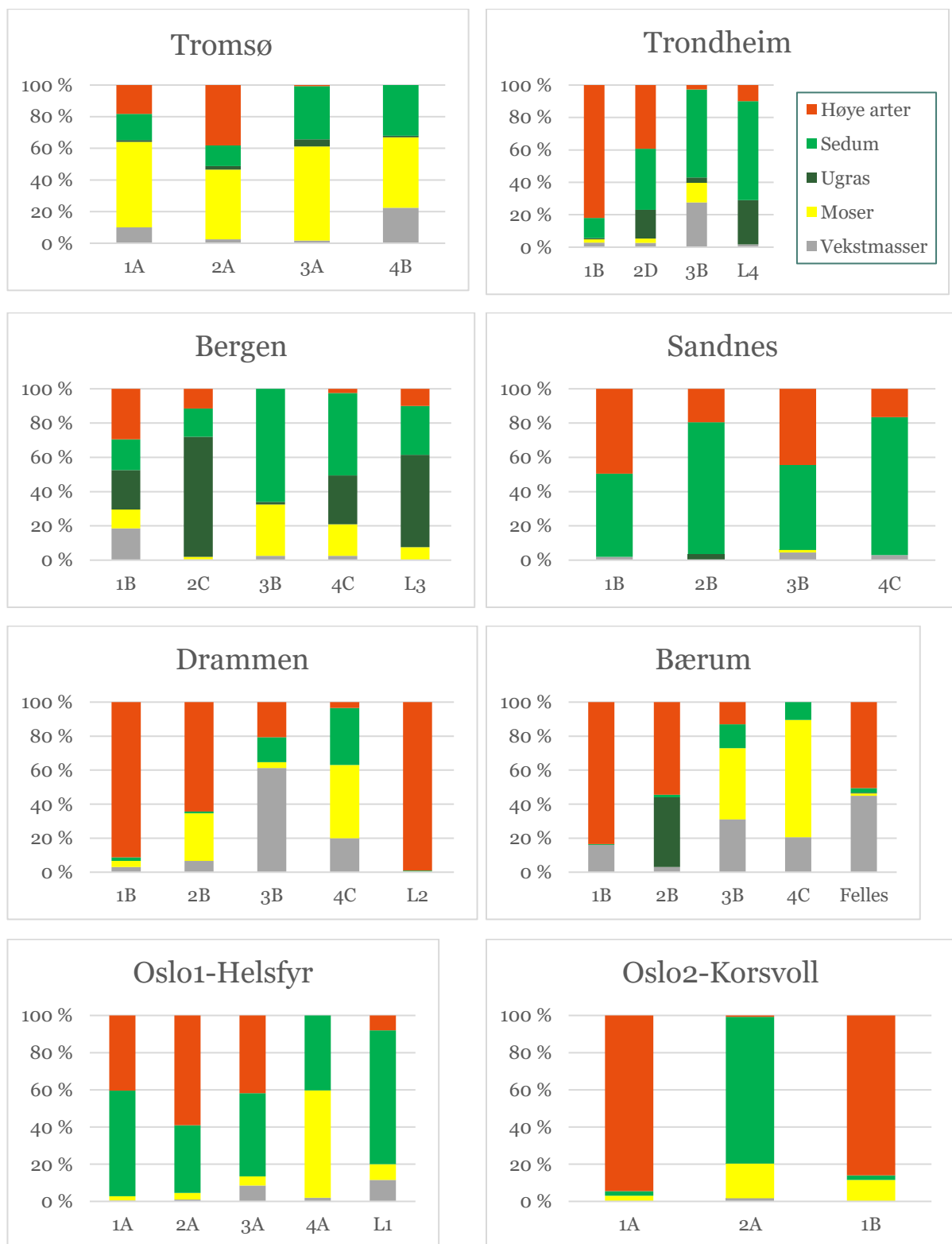
Figur 2. Dekningsgrad i de ulike takrutene fordelt på eksponert substrat, moser, ugras, lave Sedum arter og høye arter ( Hylotelephium og Phedimus arter). Koder langs x-aksen viser til systemene for takoppbygging vist i vedlegg 1.
