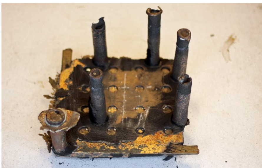
Figur 20 Bildet viser plate 3 før fjerning av toppmatere og løpsystem. De hvite stripene skyldes oppskraping fra fjerning av støpesand.
