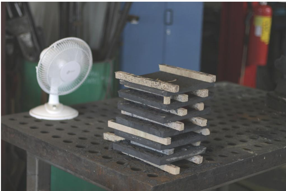
Figur 16 Bildet viser hvordan det ble benyttet bordvifte til tvungen konveksjon ved avkjøling i luft.
