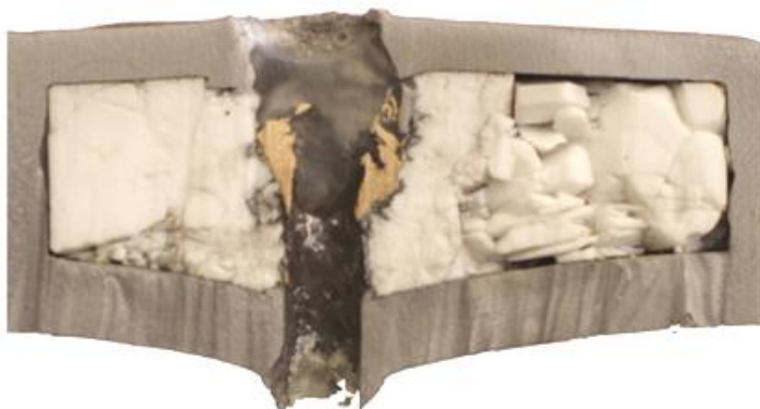
Figur 55 Tverrsnittsbilder av penetrasjon med 7,62 mm AP ammunisjon.
