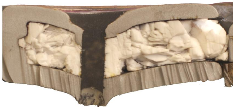
Figur 56 Tverrsnittsbilder av penetrasjon med 12,7 mm AP ammunisjon.
