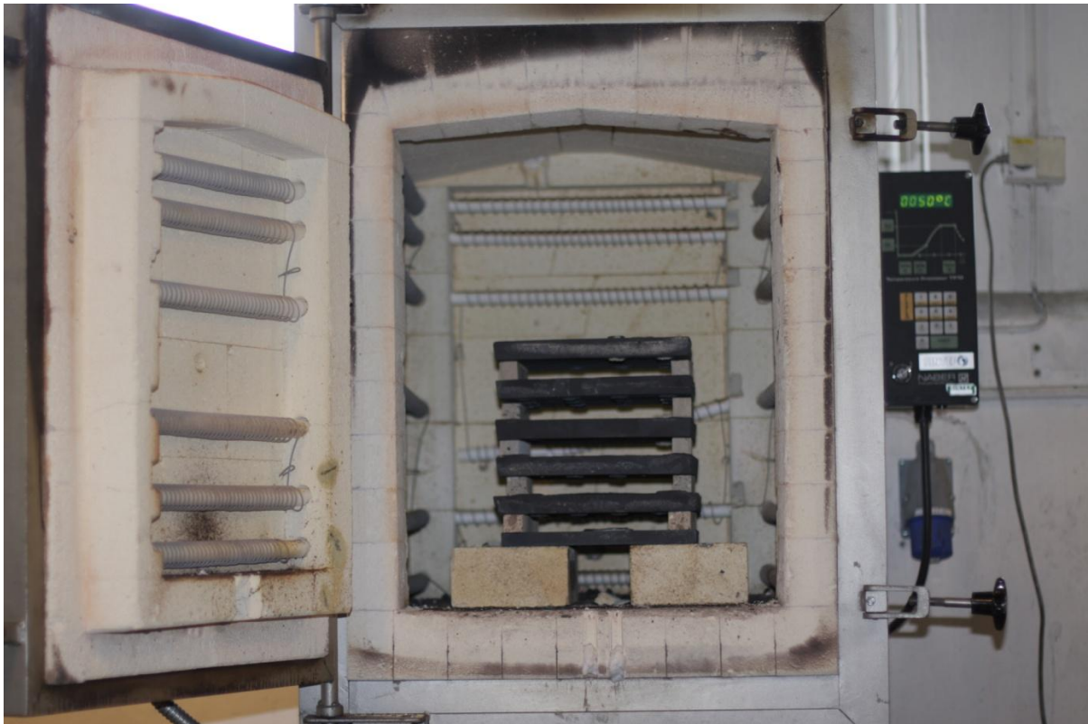
Figur 15 Bilde av hvordan platene ble stablet i ovnen.
