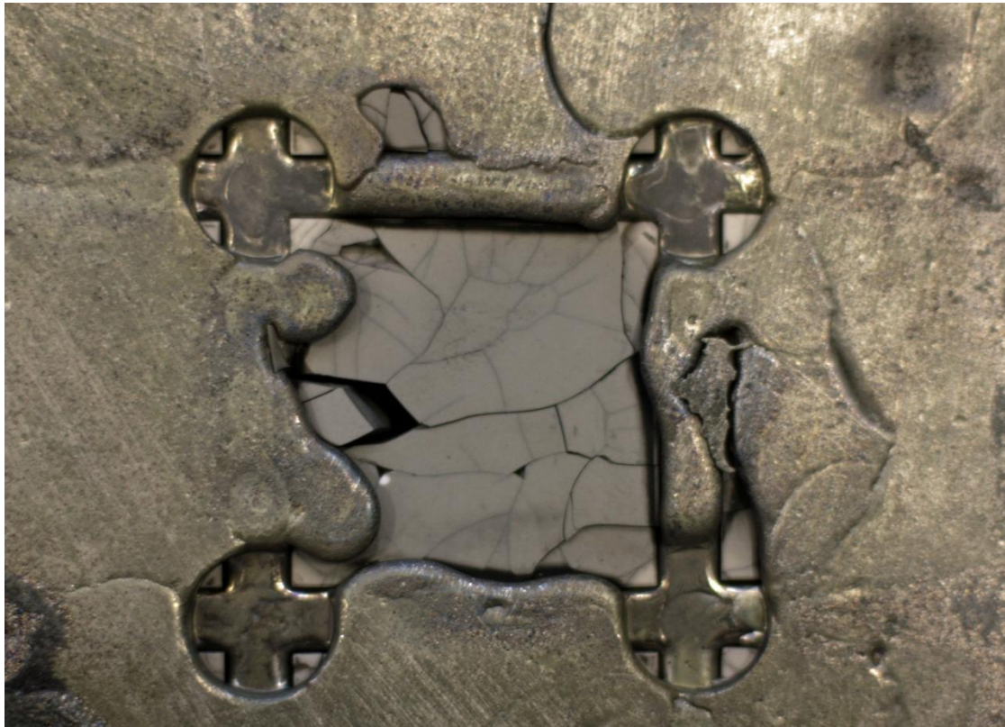
Figur 24 Bilde av flis plassert i midten av Plate 4. Smelten har her størknet for tidlig og midtflisen ligger åpen. Bildet viser hvordan keramet har sprukket opp under støpingen. Flisen er intakt og ligger der den skal, tross oppsprekkingen.
