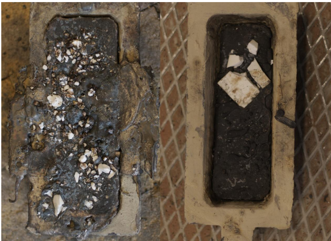
Figur 23 Bildet til venstre viser restene av en aluminaflis som ikke var forvarmet før tilføring av smelte ved 1700 °C. Bildet til høyre viser en flis forvarmet til 800 °C før tilføring av smelte ved 1700 °C.
