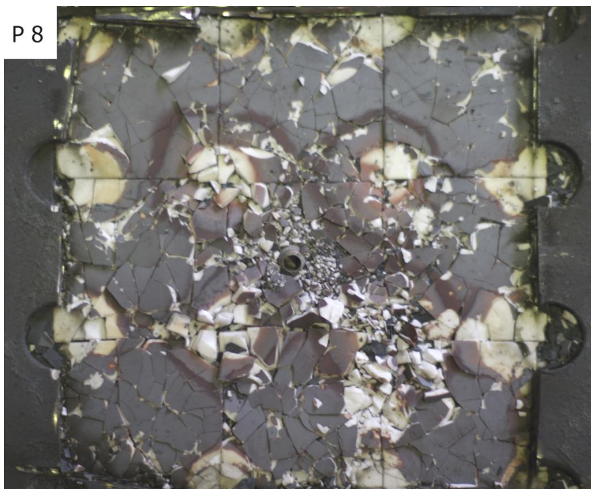
Figur 39 Bilde av Plate 8 etter at fremre del av platen ble kuttet vekk. Kobberkappen til prosjektilet ligger igjen i senterflisen som er sprukket opp i langt større grad enn naboflisene. De hvitere områdene(ikke sirkelene) skyldes avskalling under fjerning av forstrukturen.
