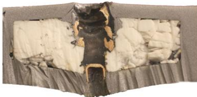
Figur 54 Tverrsnittsbilder av penetrasjon med 7,62 mm AP ammunisjon.
