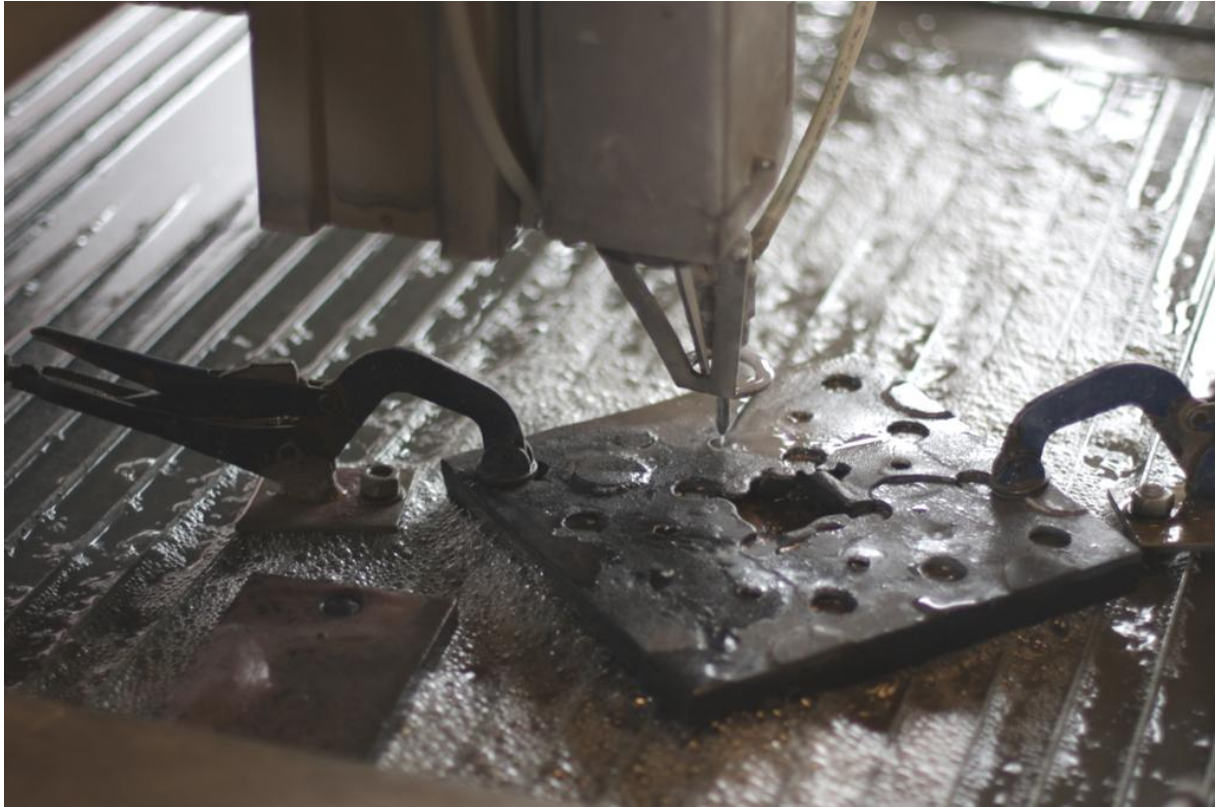
Figur 50 Bilde fra vannskjæring av Plate 4.
