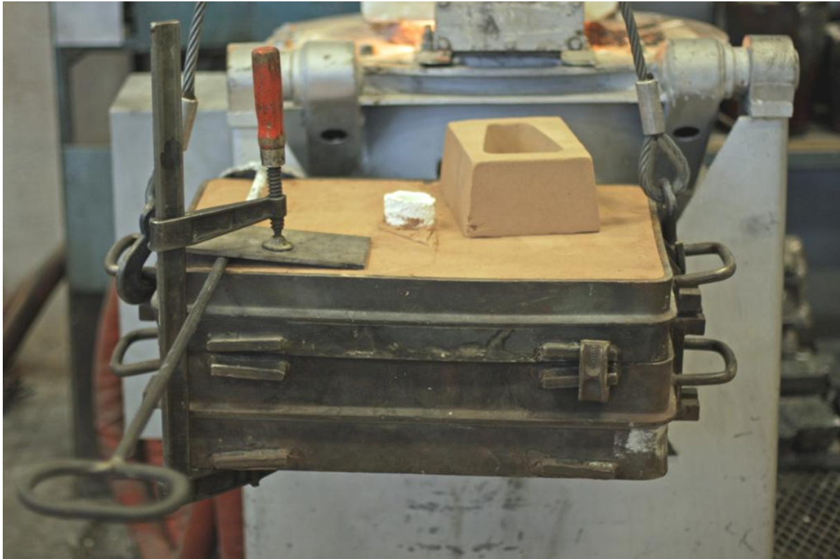
Figur 49 Bildet viser hvordan støpeformen er festet med kroker til kran og hvordan styrestag er festet med håndvinge for bedre kontroll under utstøpingen. Bildet viser støpeformen til en av platene uten keram, og har derfor kun 1 sentrert toppmater.
