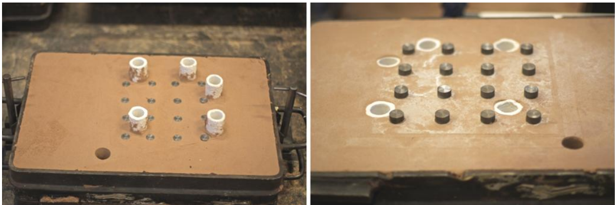
Figur 47 Bildet til venstre viser toppkassen med fire toppmatere, fikseringsstøttene som ble vektet under støpingen og hull til løpkopp. Bildet til høyre viser undersiden av toppkassen med fikseringsstøttene stikkende ut slik at de legger press på flisene.
