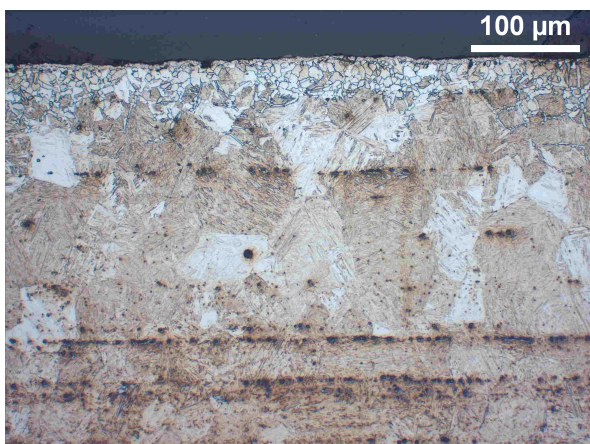
(e) 46Si7, 1000 °C, 15 min, valset side. Avkullingsdybde: 215 μm
