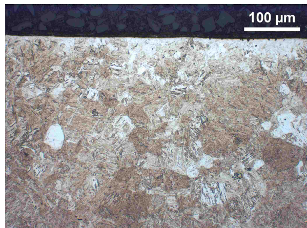
(d) 35M13B, 950 °C, 15 min, slipt side. Avkullingsdybde: 127 µm
