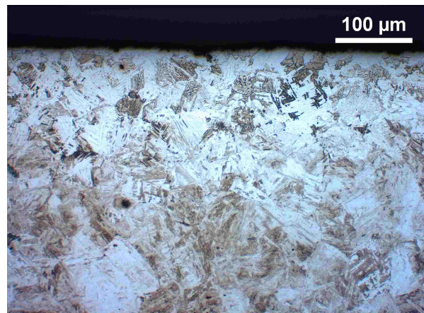
(f) 35M13B, 1000 °C, 60 min, slipt side. Avkullingsdybde: 650 μm
