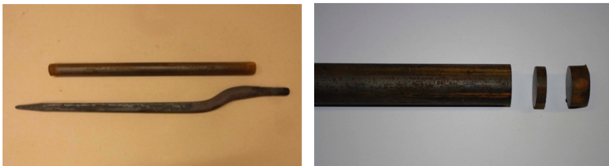
(a) Tindeemne og en ferdig produsert tind smidd av et slikt emne. (b) Skiver med en tykkelse på 1 cm ble kuttet av emnet og brukt til varmebehandlingsforsøk.
