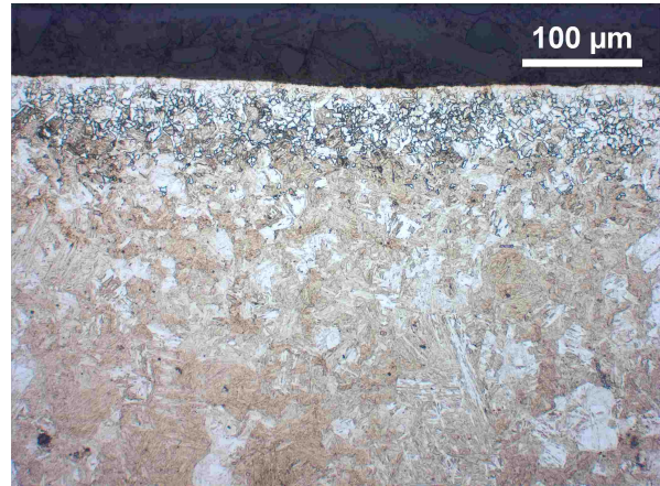
(b) 35M13B, 900 °C, 60 min, slipt side. Avkullingsdybde: 225 μm
