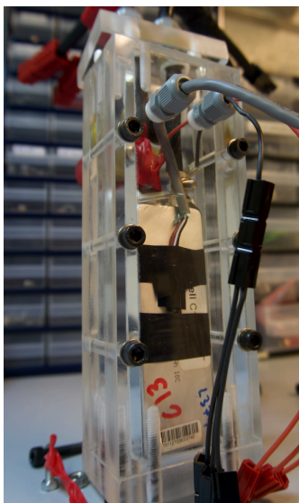
Figur 4-4 Bilde at test boks med en battericelle inni for å kunne teste PCM. Test utført ved IFE.
