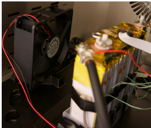
Figur 5-12 Viser hvordan vifte og modul er plassert ved parallellkjøring. I dette bilde er riggen ikke inkludert. Test utført ved IFE.
