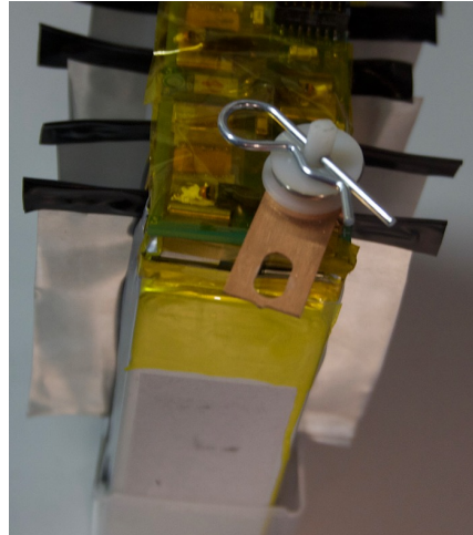
Figur 5-9 Bilde av hvordan kjøleriggen av aluminiumsplater er plassert og satt opp.
