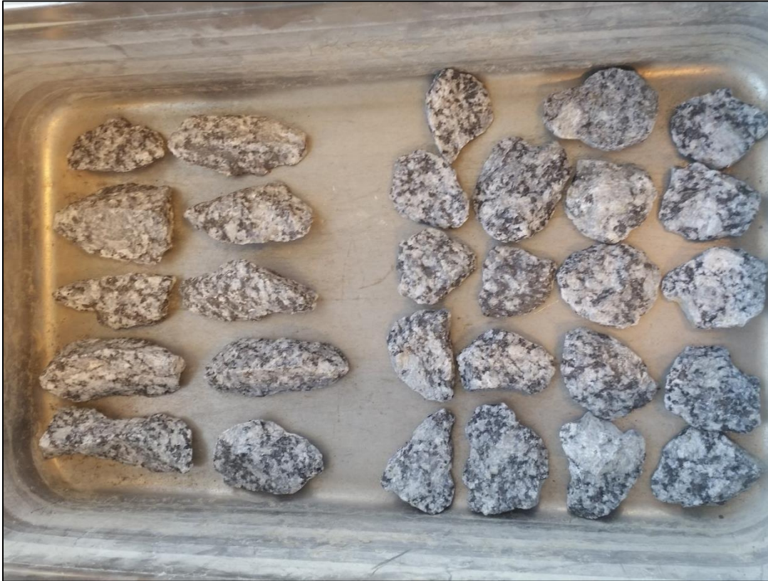
Figur 5.1 Stenglige korn som følge av stor lengste dimensjon eller liten minste dimensjon.
