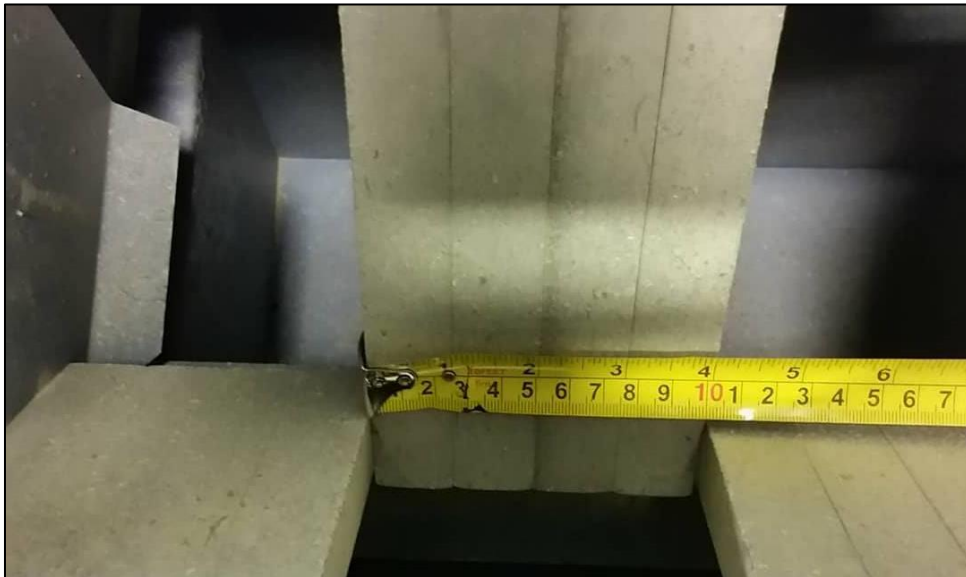
Figur 3.2 Spalteåpning ved splitting av 0-90 mm-materialene.
