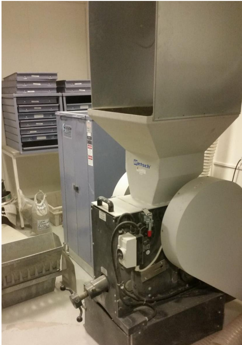
Figur 2.25 Kjevteknuseren ved Sentrallaboratoriet som er benyttet i arbeidet med oppgaven.
