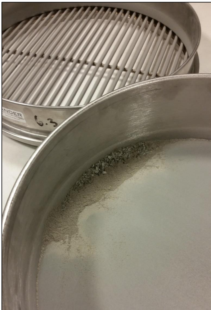
Figur 5.5 Finstoffproduksjon som følge av en sikteoperasjon med stavsikt.
