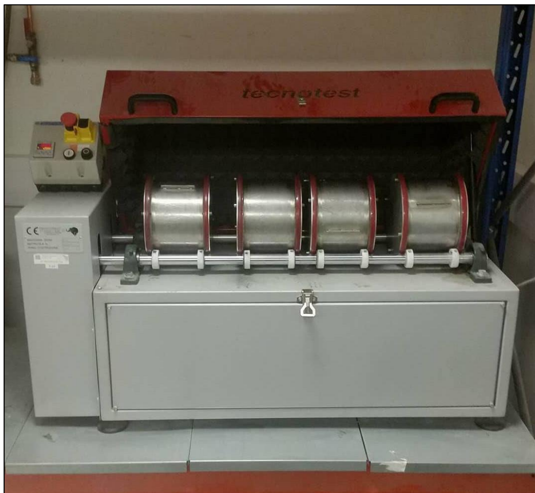
Figur 2.13 Micro-Deval-apparatet som står på Sentrallaboratoriet i Trondheim.
