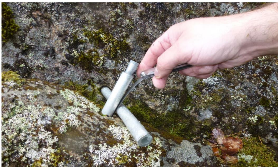
Figur 3-13. Registrering av rørsler med bladsøker på målebolt 2 ved Sjøåsblokka. Foto: Roar Gartland.
